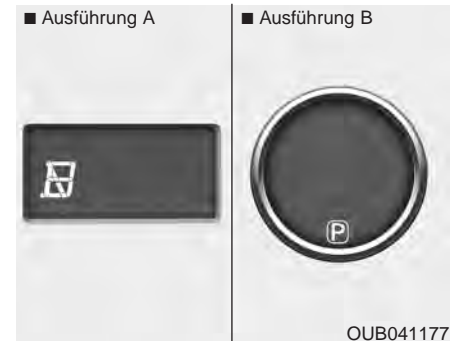
Schaltstufenanzeige Automatikgetriebe (ausstattungsabhängig)
