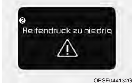
Warnleuchte für zu geringen Reifenluftdruck (1) / TPMS-Störungsleuchte (2)
