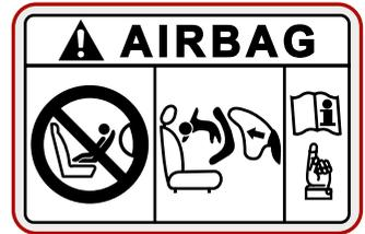
Installieren Sie niemals ein Kinderrückhaltesystem auf dem Beifahrersitz, solange der Beifahrerairbag nicht deaktiviert wurde. Wenn der Airbag ausgelöst wird, kann er auf das Kinderrückhaltesystem prallen und dem Kind schwere oder tödliche Verletzungen zufügen.
