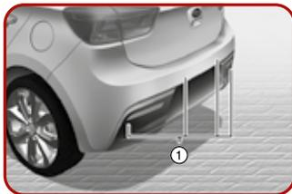
Die Einparkhilfe hinten unterstützt den Fahrer beim Rückwärtsfahren und gibt einen Warnton aus, wenn sie innerhalb einer Distanz von 120 cm hinter dem Fahrzeug ein Hindernis erkennt.
