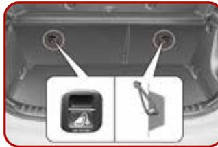
Kinderrückhaltesystem mit einem Halteband an einem oberen Ankerpunkt\* im Fahrzeug sichern. Siehe Betriebsanleitung [3].
