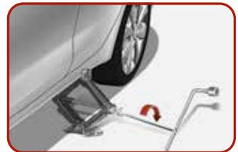
8. Führen Sie die Wagenheberkurbel in den Wagenheber und drehen Sie die Kurbel so lange im Uhrzeigersinn, bis das Rad den Boden nicht mehr berührt bzw. sich ca. 30 mm über dem Boden befindet.
