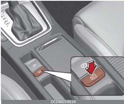
1. Wenn die Fahrertür, die Motorhaube und der Kofferraum geschlossen sind, schnallen Sie sich an oder treten Sie das Bremspedal und drücken Sie dann die Taste Auto Hold. Die weiße AUTO HOLD-Kontrollleuchte leuchtet, d. h., das System ist betriebsbereit.
