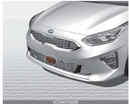
Damit Der FCA ordnungsgemäß funktioniert, müssen Sie die Sensorabdeckung bzw. den Sensor immer sauber und frei von Schmutz, Schnee und Schmutz halten.
