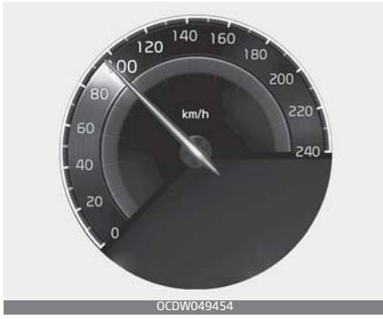
Der Tachometer zeigt die Geschwindigkeit des Fahrzeugs an und ist in Meilen/Stunde (mph) bzw. in Kilometern/Stunde (km/h) kalibriert.
