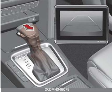
Der Rückfahrmonitor ist eine ergänzende Funktion, die den Bereich hinter dem Fahrzeug auf dem Bildschirm des Infotainmentsystems anzeigt, um Sie beim Parken oder Fahren zu unterstützen.
