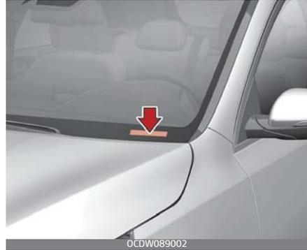
Die Fahrzeug-Identifizierungs-Nummer (FIN) ist auch auf dem Typenschild an der Oberseite des Armaturenbretts angegeben. Die Nummer auf dem Typenschild kann von außen bequem durch die Windschutzscheibe abgelesen werden.
