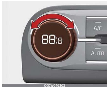
Durch Drehen des Temperaturreglers bis in die äußerste rechte Reglerstellung wird die maximale Temperatur (HI) erreicht.
