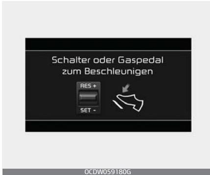
Wenn die intelligente Tempomatsteuerung in Betrieb ist, stoppt Ihr Fahrzeug hinter dem vorausfahrenden Fahrzeug, wenn dieses anhält. Die Meldung wird auf dem Kombiinstrument innerhalb von 3 Sekunden nach dem Stopp angezeigt, das System bleibt danach im Standby-Betrieb.
