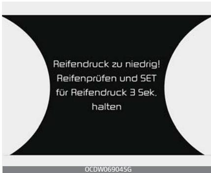
Wenn die Kontrollleuchten des Reifendruck-Überwachungssystems leuchten und eine Warnmeldung auf dem LCD-Display des Kombiinstruments angezeigt wird, ist der Reifendruck in mindestens einem Reifen zu niedrig. Die Anzeige für niedrigen Reifendruck zeigt an, bei welchem Reifen der Reifendruck deutlich niedrig ist.
