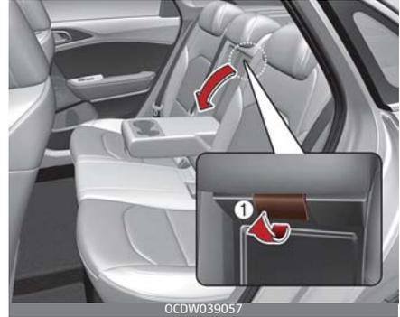
Lange Objekte können verstaut werden, indem die mittlere Rücksitzlehne umgelegt wird, ohne dass die gesamten Rücksitze umgelegt werden müssen. Siehe die folgenden Schritte zum Umlegen der mittleren Rücksitzlehne.
