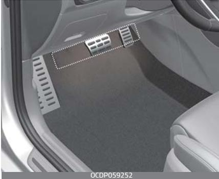
Wenn der Scheinwerfer eingeschaltet ist, ist auch das Umgebungslicht eingeschaltet. Die Ambientebeleuchtung kann im Infotainment-Menü eingestellt werden.
