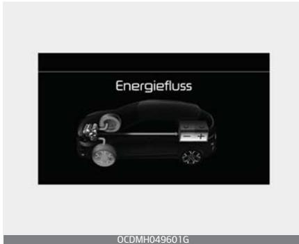
Der Motor und die Nutzbremseanlage laden die Hochspannungsbatterie. (Verbrennungsmotor & Rad → Batterie)
