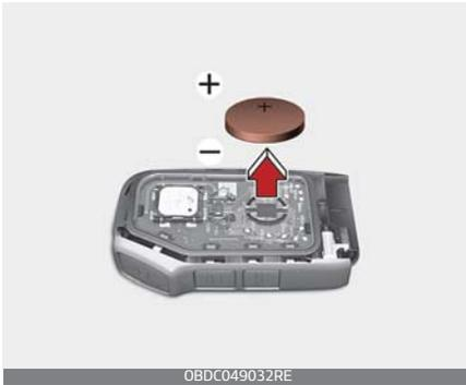
Der Handsender enthält eine 3 V-Lithium-Batterie, die normalerweise mehrere Jahre lang nicht ausgetauscht werden muss. Wenn die Batterie ersetzt werden muss, gehen Sie wie folgt vor:
