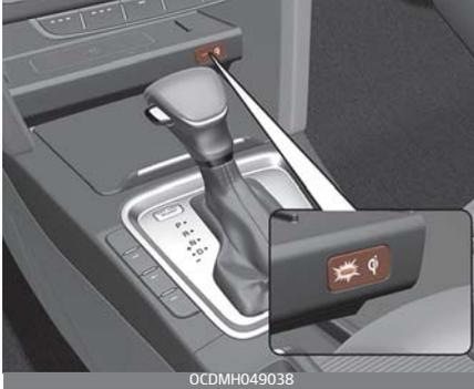
Achten Sie darauf, dass alle Türen vollständig geschlossen sind und stellen Sie die Zündung auf ACC oder IGN ON. Legen Sie das mit einer Wireless-Ladefunktion ausgestattete Mobiltelefon auf das Lade-Pad für drahtloses Laden.
