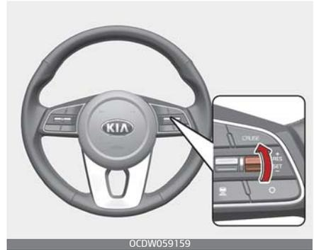
Wenn Sie die Tempomatgeschwindigkeit anders als mit der Fahrassistent-Taste deaktivieren wollen und die Funktion noch aktiviert ist, wird die zuletzt eingestellte Geschwindigkeit automatisch wieder aufgenommen, wenn Sie den Schalter nach oben (in Richtung RES+) bewegen.
