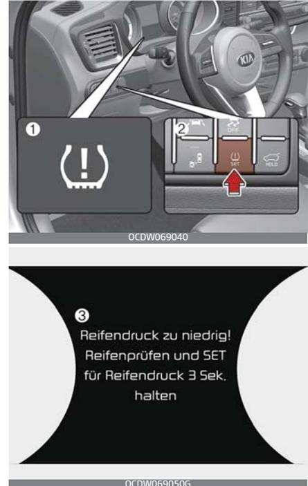
1. Warnleuchte für Reifendefekt/ TPMS-Störungsleuchte
