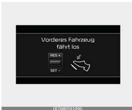
Wenn der Fahrer nach dem Losfahren des vor ihm stehenden Fahrzeugs nicht innerhalb einer bestimmten Zeit reagiert, wird die
