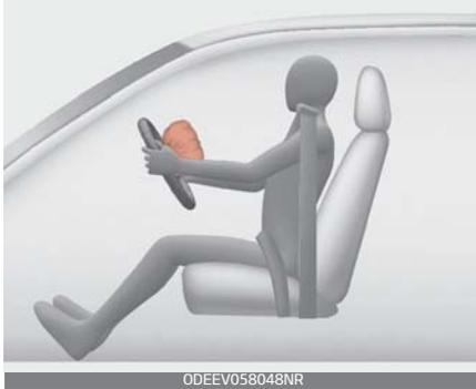
Die beiden Airbagmodule befinden sich in der Mitte des Lenkrads und im Armaturenbrett über dem Handschuhfach. Wenn das SRS-Steuergerät einen ausreichend schweren Aufprall an der Fahrzeugfront erkennt, löst es automatisch die Frontairbags aus.
