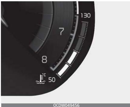
Dieses Messgerät zeigt die Temperatur des Motorkühlmittels an, wenn sich der Zündschalter oder der Knopf ENGINE START/STOP (Motorstart/-stopp) in Position ON befindet.
