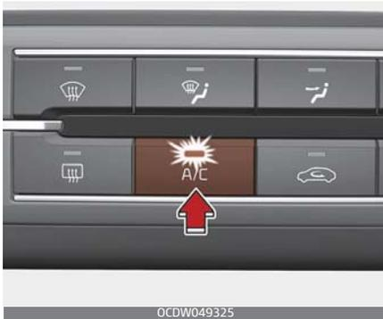
Drücken Sie die Taste A/C, um die Klimaanlage einzuschalten. Die Kontrollleuchte im Schalter leuchtet bei eingeschalteter Klimaanlage auf.
