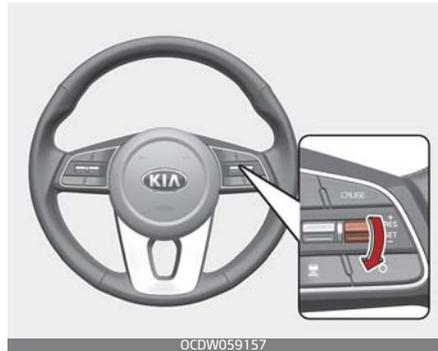
3. Drücken Sie den Schalter nach unten (in Richtung SET-) und lassen Sie ihn bei Erreichen der gewünschten Geschwindigkeit los. Die eingestellte Geschwindigkeit und der Abstand zum vorausfahrenden Fahrzeug erscheinen auf dem Bildschirm.
