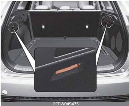
Die Kofferraumleuchte wird beim Öffnen der Heckklappe aktiviert.
