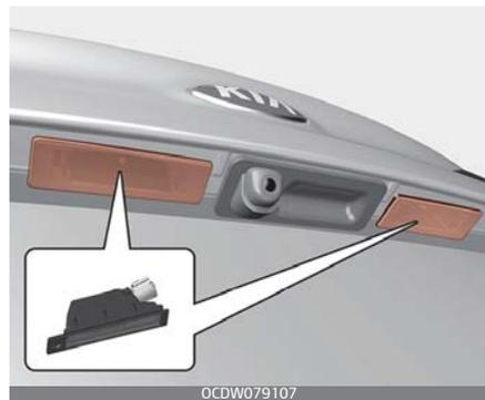
1. Entfernen Sie die Lampenbaugruppe mit einem Schraubenzieher.
