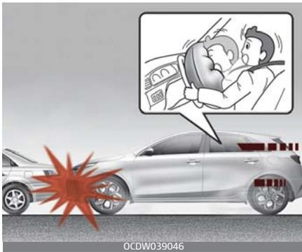
Frontairbags werden in der Regel bei einem Frontalaufprall ausgelöst. Die Auslösung hängt von der Intensität, der Geschwindigkeit und dem Aufprallwinkel ab.
