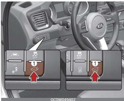
1. Taste zum Öffnen/Schließen der elektrischen Heckklappe
