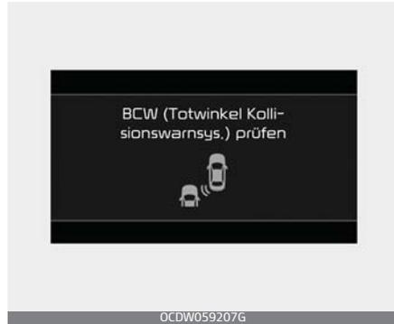
Wenn die Funktion nicht ordnungsgemäß funktioniert, erscheint eine Warnmeldung und das Licht auf dem Schalter erlischt. Die Funktion schaltet sich automatisch aus.
