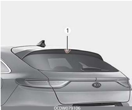
Wenn die dritte Bremsleuchte (LED) (1) nicht funktioniert, lassen Sie das Fahrzeug von einer Fachwerkstatt überprüfen.
