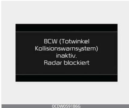
Die Meldung weist den Fahrer darauf hin, dass sich Fremdkörper auf dem bzw. im hinteren Stoßfänger befinden oder der Bereich am hinteren Stoßfänger heiß ist. Das Licht auf dem Schalter und das System schalten sich automatisch aus.
