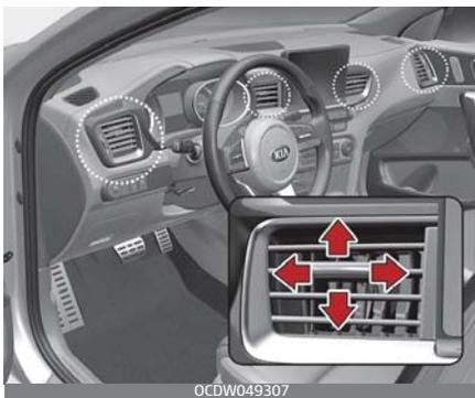
Die Düsen können separat mit dem horizontalen Stellrad geöffnet und geschlossen werden. Um die Öffnung zu schließen, drehen Sie den Regler nach unten in die maximale Position. Um die Öffnung zu öffnen, drehen Sie den Regler nach oben in die gewünschte Position.
