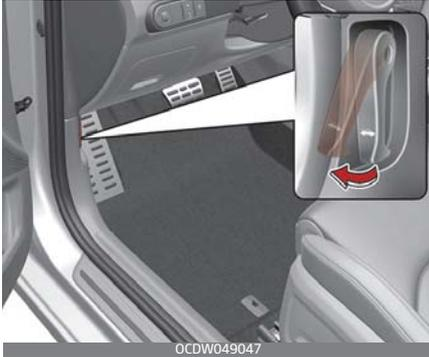
1. Ziehen Sie den Entriegelungshebel, um die Motorhaube zu entriegeln. Die Haube sollt sich um ein kleines Stück anheben.
