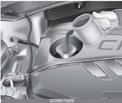
Wenn sich der Füllstand in der Nähe der Markierung D befindet, füllen Sie Öl nach, bis die Markierung C erreicht ist. **Füllen Sie nicht zu viel Öl nach.**
