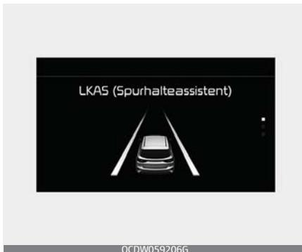
Wenn die Geschwindigkeit des Fahrzeugs über 60 km/h liegt und die Funktion die Fahrspurmarkierung erkennt, ändert sich die Farbe von grau auf weiß.
