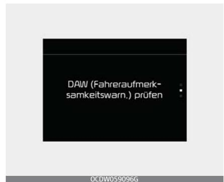
Wenn die Warnmeldung „Check System“ (System prüfen) angezeigt wird, arbeitet die Funktion nicht ordnungsgemäß. In diesem Fall sollten Sie das Fahrzeug von einem Kia-Vertragshändler überprüfen lassen.
