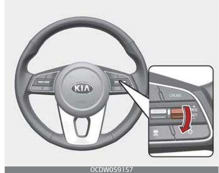
3. Drücken Sie den Schalter nach unten (in Richtung SET-) und lassen Sie ihn bei Erreichen der gewünschten Geschwindigkeit los. Die Sollgeschwindigkeit für den Tempomatbetrieb wird angezeigt. Lassen Sie gleichzeitig auch das Gaspedal los. Die eingestellte Geschwindigkeit wird nun automatisch beibehalten.
