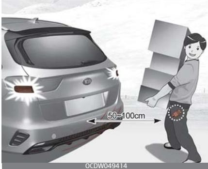
Wenn Sie sich im Erkennungsbereich (50 bis 100 cm hinter dem Fahrzeug) mit einem Smart-Key befinden, blinken die Warnleuchten und es ertönt ca. 3 Sekunden lang ein akustisches Warnsignal, um Sie darauf hinzuweisen, dass der Smart-Key erkannt wurde und die Heckklappe sich öffnet.
