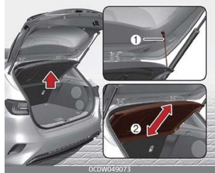
Die Kofferraumabdeckung wird angehoben, wenn die Heckklappe geöffnet wird.
