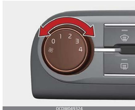
Mit diesem Drehknopf können Sie die Lüfterdrehzahl einstellen, um den aus den Lufterdosen strömenden Luftstrom zu regulieren.
