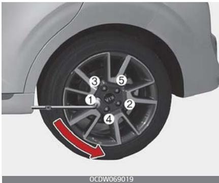
6. Lösen Sie alle Radmuttern um eine Umdrehung gegen den Uhrzeigersinn. Schrauben Sie Radmuttern erst ab, wenn das Rad soweit angehoben wurde, dass es den Boden nicht mehr berührt.
