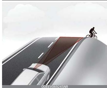
Die Leistung des FCA verschlechtert sich bei Bergauf- oder Bergabfahrten, das vorausfahrende Fahrzeug auf der gleichen Spur wird nicht erkannt. Möglicherweise werden grundlos Warnmeldungen und
