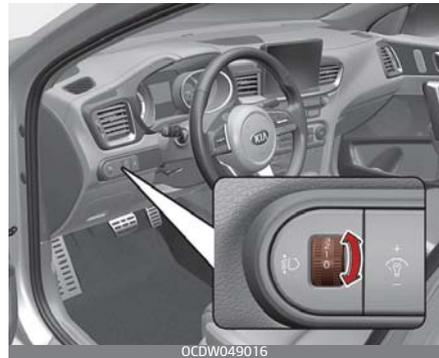
Um die Leuchtweite entsprechend der Anzahl der Insassen und dem zugeladenen Gewicht im Kofferraum einzustellen, drehen Sie das Stellrad.
