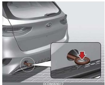
1. Öffnen Sie die Heckklappe und entnehmen Sie die Abschleppöse aus dem Werkzeugeinsatz.
