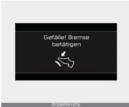
Diese Warnmeldung erscheint, wenn das Fahrzeug langsam auf einer Böschung fährt und das Fahrzeug erkennt, dass das Bremspedal nicht betätigt wird.
