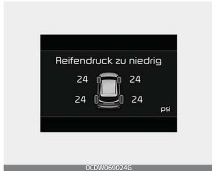
Wenn die Kontrollleuchten des Reifendruck-Überwachungssystems leuchten und eine Warnmeldung auf dem LCD-Display des Kombiinstrumentes angezeigt wird, ist der Reifendruck in mindestens einem Reifen zu niedrig. Die Positionskontrollleuchte für Reifen mit geringem Reifendruck zeigt an, in welchem Reifen der Reifendruck erheblich zu gering ist. Dazu wird die Position des
