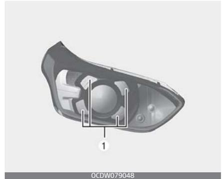
Wenn Positionslampe + Tagfahrlicht (1) nicht funktionieren, lassen Sie das Fahrzeug von einer Fachwerkstatt überprüfen.
