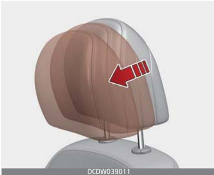
Die Kopfstütze kann nach vorn in 4 verschiedene Stellungen gebracht werden, indem Sie die Kopfstütze in die gewünschte Stellung nach vorn ziehen.
