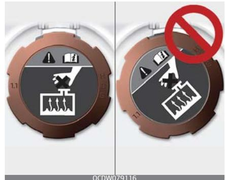
2. Stellen Sie sicher, dass die kleinen Vorsprünge im Kühlmitteldeckel sicher eingerastet sind.
