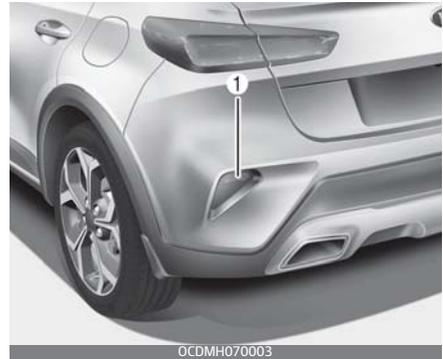
Wenn der Nebelscheinwerfer (LED) (1) nicht funktioniert, lassen Sie das Fahrzeug von einer Fachwerkstatt überprüfen.
