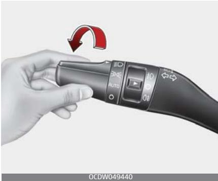
In der Schalterstellung „Scheinwerfer“ (3. Stellung) sind Scheinwerfer, Rückleuchten, Positionsleuchten, Kennzeichenbeleuchtung und Armaturenbeleuchtung eingeschaltet.
