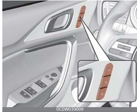
Eine Fahrersitz-Memoryfunktion speichert und lädt die Fahrersitzeinstellungen per Tastendruck. Durch Speicherung der bevorzugten Position im Systemspeicher können verschiedene Fahrer den Fahrersitz ihren Wünschen anpassen. Bei abgeklemmter Batterie wird der Fahrersitzspeicher gelöscht und die Fahrpositionen müssen im System wieder neu eingestellt werden.
