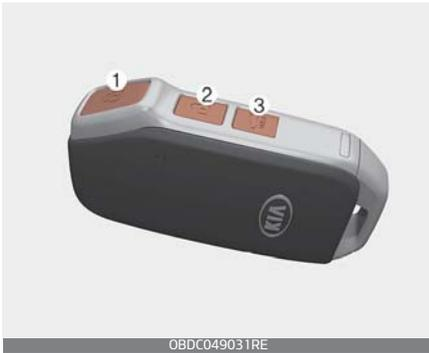
Mit einem Smart-Key können Sie Türen (und Heckklappe) ver- und entriegeln und auch den Motor starten, ohne dass Sie einen Schlüssel in ein Schloss stecken.
