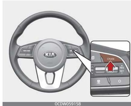
1. Drücken Sie die Fahrassistent-Taste, um das System einzuschalten. Die TEMPOMAT-Kontrollleuchte im Kombiinstrument leuchtet danach auf.
