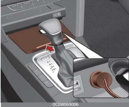
9. Schließen Sie den Kompressor mit dem Kabel und den Verbindern an die Fahrzeug-Steckdose an.
