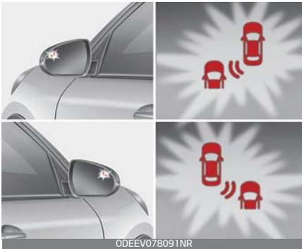
Wenn ein Fahrzeug innerhalb der Erkennungsgrenzen der Funktion erkannt wird, leuchtet eine Warnleuchte an den Außenspiegeln.
