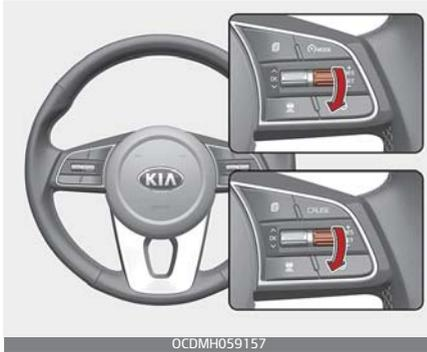
1. Drücken Sie die Fahrassistent-Taste am Lenkrad, um die Funktion einzuschalten. Die Sollgeschwindigkeit wird angezeigt.
