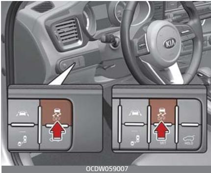
Die ESC kann einzelne Räder abbremsen und greift in die Motorsteuerung ein, wenn das Fahrzeug stabilisiert werden muss.
