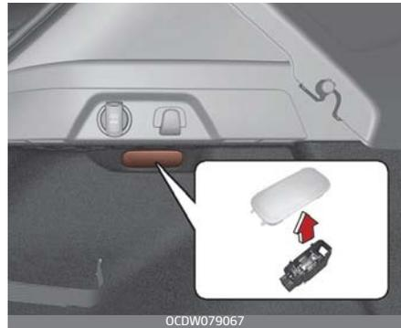
1. Lösen Sie die Leuchtenbaugruppe vorsichtig mit einem flachen Schraubendreher aus dem Gehäuse.
