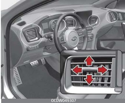
Die Düsen können separat mit dem Stellrad geöffnet und geschlossen werden. Um die Öffnung zu schließen, drehen Sie den Regler nach unten in die maximale Position. Zusätzlich können Sie an diesen Düsen die Richtung des Luftstroms durch Betätigung des Einstellhebels verändern, siehe Abbildung.
