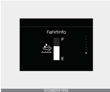
Die Harnstoffanzeige zeigt die im Harnstofftank befindliche Restmenge der Harnstofflösung an.
