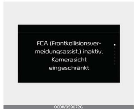
Wenn die Kamera durch Schmutz, Schnee oder Fremdkörper zugesetzt ist, kann der FCA-Betrieb vorübergehend eingestellt werden. In diesem Fall wird der Fahrer durch eine
