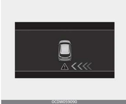
Wenn die Sensoren des Fahrzeugs erkennen, dass sich ein Fahrzeug Ihrem Fahrzeug von links hinten/ rechts hinten nähert, ertönt ein akustisches Warnsignal, die Warnleuchte am Außenspiegel blinkt, und es erscheint eine entsprechende Meldung auf dem LCD-Display. Wenn das Rückfahrmonitorsystem aktiviert ist, erscheint zusätzlich eine Meldung auf dem Bildschirm des Infotainmentsystems.
