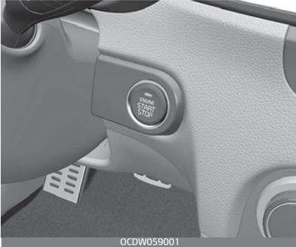
Wenn die vordere Tür geöffnet wird, leuchtet der Knopf ENGINE START/STOP (Motorstart/-stopp) auf. Das Licht erlischt nach etwa 30 Sekunden, nachdem die Tür geschlossen wurde. Erlischt ebenfalls sofort, wenn die Diebstahlwarnanlage aktiviert wird.
