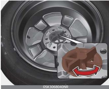
Drehen Sie die Flügelschraube, die das Ersatzrad fixiert, gegen den Uhrzeigersinn. Verstauen Sie das Rad in der umgekehrten Reihenfolge des Ausbaus.
