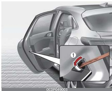
Wenn die elektrische Türverriegelung nicht funktioniert, lässt sich die Tür nur mit dem mechanischen Schlüssel von außen schließen.
