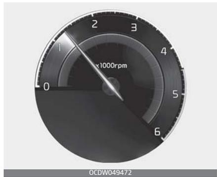
Der Drehzahlmesser zeigt die ungefähre Motordrehzahl in Umdrehungen pro Minute (U/min) an.
