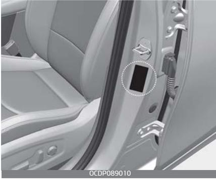
Der Aufkleber „Typenzulassung“ befindet sich auf der Fahrerseite außen an der B-Säule und beinhaltet die Fahrzeug-Ident.-Nr. (VIN).
