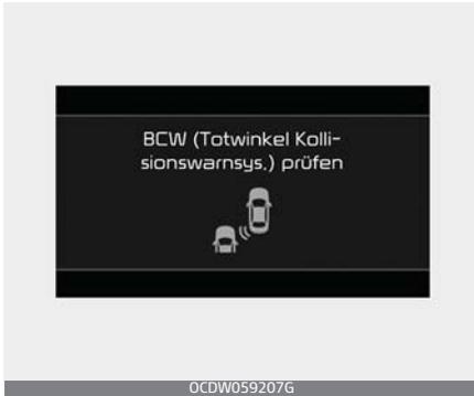
Wenn die Funktion nicht ordnungsgemäß arbeitet, erscheint eine Warnmeldung und das Licht auf dem Schalter erlischt. Die Funktion wird automatisch abgeschaltet.
