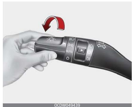
In der Schalterstellung „Standlicht“ (2. Stellung) sind Rückleuchten, Positionsleuchten, Kennzeichenbeleuchtung und Armaturenbeleuchtung eingeschaltet.
