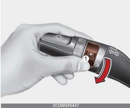
Um die Nebelschlussleuchte einzuschalten, drehen Sie den Nebelschlussleuchtschalter (1) in die Position ON, wenn das Licht eingeschaltet ist.
