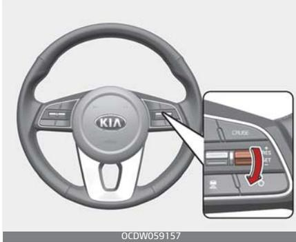
3. Drücken Sie den Schalter nach unten (in Richtung SET-) und lassen Sie ihn bei Erreichen der gewünschten Geschwindigkeit los. Die eingestellte Geschwindigkeit und der Abstand zum vorausfahrenden Fahrzeug erscheinen auf dem LCD-Bildschirm.
