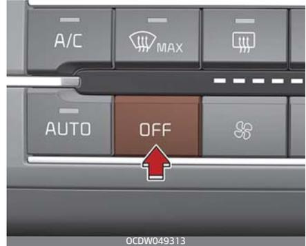
Drücken Sie die Taste OFF, um die Klimaanlage auszuschalten. Die Frischluft-/Umluftschtung können jedoch weiterhin bedient werden, solange die Zündung eingeschaltet ist.
