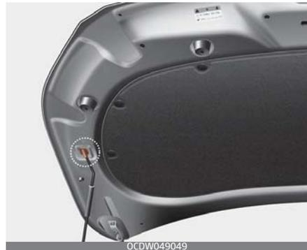
3. Ziehen Sie die Haubenstützstange von der Motorhaube.
