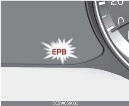
Wenn die EPB-Störungsanzeige ständig leuchtet, zeigt sie an, dass die EPB möglicherweise defekt ist. Lassen Sie die Anlage in diesem Fall von einer Fachwerkstatt überprüfen. Kia empfiehlt den Besuch eines Kia-Vertragshändlers/Servicepartners.
