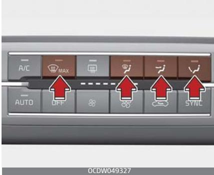
Die Modustaste steuert die Richtung des Luftstroms im Belüftungssystem.
