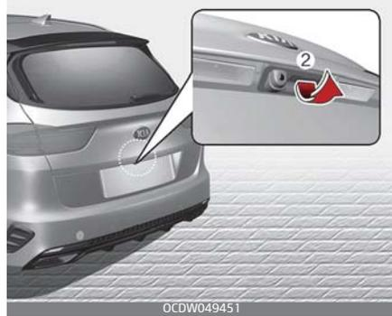
2. Griffschalter für die elektrische Heckklappe
