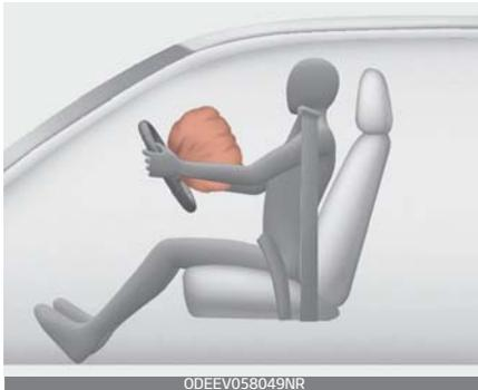
Bei der Auslösung trennen sich Sollrissnähte, die direkt in die Verkleidungen eingearbeitet sind, unter dem Druck der Airbagausdehnung. Die daraufhin entstehenden Öffnungen in den Abdeckungen erlau-
