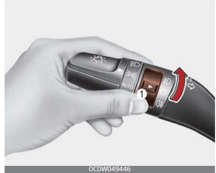
Die Nebelscheinwerfer sollen die Sicht bei schlechten Sichtbedingungen, beispielsweise Nebel, Regen oder Schnee verbessern. Die Nebelscheinwerfer werden eingeschaltet, wenn der Nebelscheinwerferschalter (1) nach dem Einschalten des Standlichts in die Stellung EIN gedreht wird.
