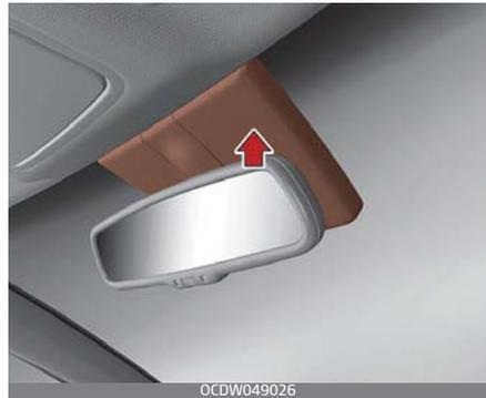
Die automatische Scheibenheizung verringert die Wahrscheinlichkeit von Beschlagbildung auf der Innenseite der Windschutzscheibe, indem Feuchtigkeit an der Innenseite der Windschutzscheibe automatisch erkannt und der Luftstrom zur Windschutzscheibe erhöht wird.
