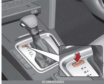
Wenn sich der Wählhebel von der Parkstufe (P) bei betätigtem Bremspedal nicht in den Rückwärtsgang (R) bewegen lässt, halten Sie das Bremspedal getreten und gehen Sie wie folgt vor:
