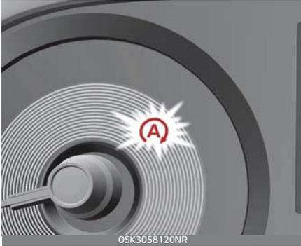
Ein Problem mit den ISG-Sensoren oder dem ISG-System auftritt.
