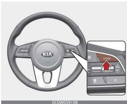
1. Drücken Sie die Fahrassistent-Taste, um die Funktion einzuschalten. Die TEMPOMAT-Kontrollleuchte im Kombiinstrument leuchtet danach auf.
