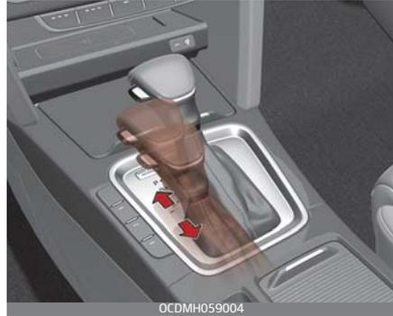
Den manuellen Modus können Sie sowohl im Stand als auch während der Fahrt wählen. Bewegen Sie dazu den Wählhebel aus der Fahrstufe (D) in die manuelle Schaltgasse. Um in die Fahrstufe (D) zurückzugelangen, bewegen Sie den Wählhebel zurück in die Automatik-Schaltgasse. Im manuellen Modus können Sie die gewünschten Gänge für die momentanen Fahrbedingungen wählen, indem Sie den Wählhebel nach vorn drücken oder nach hinten ziehen.
