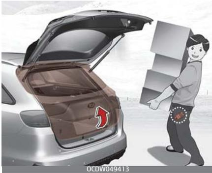
Wenn das Fahrzeug mit einem Smart-Key ausgestattet ist, kann die Heckklappe berührungslos mit dem intelligenten Heckklappensystem geöffnet werden.
