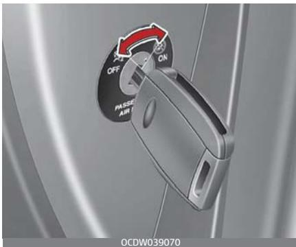
Wenn ein Kinderrückhaltesystem auf dem Beifahrersitz installiert ist oder wenn dieser Sitz nicht besetzt ist, kann der Beifahrerairbag mit dem Schalter „Beifahrer-Frontairbag ON/OFF“ deaktiviert werden.
