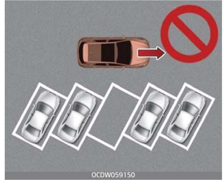
Die Funktion unterstützt paralleles oder rechtwinkliges Einparken. Ein diagonales Einparken wird nicht unterstützt. Selbst wenn das Fahrzeug in die Parklücke einfahren kann, dürfen Sie die Einparkhilfe nicht verwenden. Die Funktion versucht, immer parallel oder rechtwinklig zur Parklücke einzuparken.
