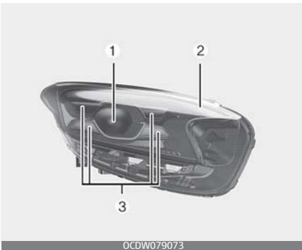
Wenn das Abblendlicht/Fernlicht (1), die vordere Blinkleuchte (2) oder die Tagesfahrleuchte/Positionsleuchte (3) nicht funktionieren, lassen Sie das Fahrzeug in einer Vertragswerkstatt überprüfen.
