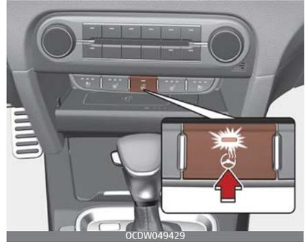
Wenn Sie bei eingeschalteter Zündung die Taste für die Lenkradheizung drücken, wird das Lenkrad erwärmt. Daraufhin leuchtet die Kontrollleuchte der Taste auf.
