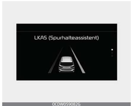
Wenn das Fahrzeug eine Spur oder Straßenkante überfährt, blinkt die überfahrene Spurmarkierung bzw. der Straßenrand auf dem LCD-Display, und es wird ein Warnton ausgegeben.
