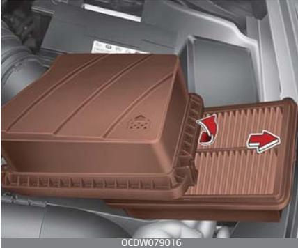
2. Reinigen Sie das Innere des Luftfilters.
