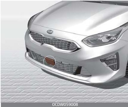
Der Sensor erkennt den Abstand zum Fahrzeug in Fahrtrichtung.
