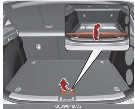
1. Erfassen Sie den Griff oben an der Abdeckung und heben Sie die Abdeckung damit an.
