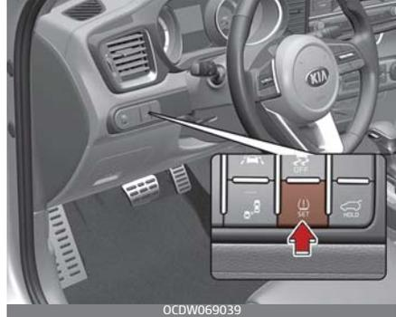
4. Überprüfen Sie dann, ob die Reifendruckanzeige nach vier Sekunden Blinken erlischt. Überprüfen Sie ggf. auf dem Überwachungsdisplay, ob die Meldung „Tire pressures stored“ (Reifendruck gespeichert) angezeigt wird.
