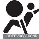
Die Airbag-Warnleuchte im Kombiinstrument soll Sie warnen, wenn mögliche Probleme mit Ihrem Airbag – SRS-System (ergänzendes Rückhaltesystem) – auftreten.
