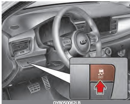
Die elektronische Stabilitätskontrolle (ESC) soll das Fahrzeug bei Kurvenfahrten in einem stabilen Zustand halten. Die ESC vergleicht den Lenkradeinschlag mit der tatsächlichen Bewegung des Fahrzeugs.
