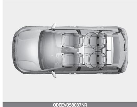
Die äußeren Rücksitze links und rechts sind mit ISOFIX-Ankerpunkten ausgestattet. Deren Einbaulage ist in der Abbildung dargestellt.
