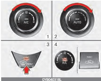
1. Stellen Sie den Lüfter auf die höchste Drehzahl (bis zum Anschlag nach rechts).
