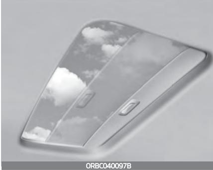
Der Sonnenschutz wird automatisch mit dem Schiebedach geöffnet. Ziehen Sie den Sonnenschutz manuell nach vorn, um ihn zu schließen.
