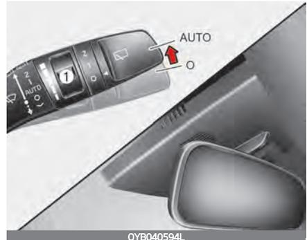
Der Regensensor, der sich am oberen Rand der Windschutzscheibe befindet, erkennt die Niederschlagsmenge und steuert die Wischzyklen entsprechend. Bei zunehmendem Niederschlag wischen die Scheibenwischer schneller. Wenn kein Niederschlag mehr fällt, stoppen die Scheibenwischer.
