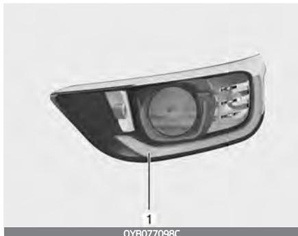
Wenn die Positionsleuchte/das Tagfahrlicht (LED) (1) nicht funktioniert, lassen Sie das Fahrzeug in einer Fachwerkstatt überprüfen.
