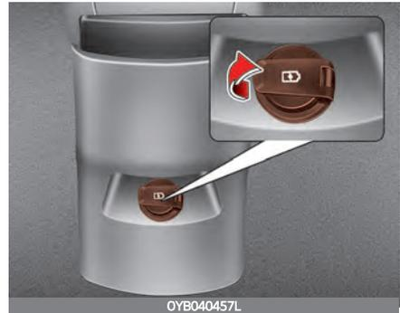
Das USB-Aufladegerät ist zur Aufladung von Akkus kleiner elektrischer Geräte über ein USB-Kabel vorgesehen. Die elektrischen Geräte können aufgeladen werden, sobald der Knopf ENGINE START/STOP (Motorstart/-stopp) in der Position ACC/ON/START steht.
