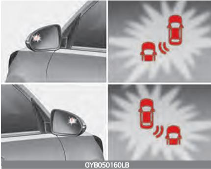
Um den Fahrer vor einem Fahrzeug zu warnen, das sich von der hinteren linken/rechten Seite Ihres Fahrzeugs nähert, blinkt der Außenspiegel, und eine Warnung erscheint auf dem Kombiinstrument. Gleichzeitig ertönt ein Warnton, und das Lenkrad vibriert. Wenn der Rückfahrmonitor aktiviert ist, erscheint zusätzlich eine Warnung auf dem Bildschirm des Infotainmentsystems.
