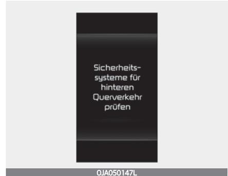
Wenn das hintere Querverkehr-Erkennungssystem nicht richtig funktioniert, erscheint die Warnmeldung „Hinteres Querverkehr-Erkennungssystem prüfen“ auf dem Kombiinstrument, und die Funktion schaltet sich automatisch aus oder wird in seiner Funktionalität eingeschränkt. Lassen Sie das Fahrzeug in diesem Fall von einer Fachwerkstatt überprüfen. Kia empfiehlt Ihnen, sich an einen Kia-Vertragshändler/Servicepartner zu wenden.
