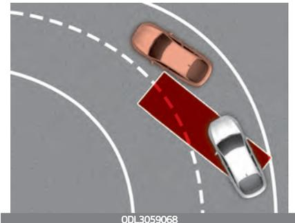
Das Totwinkel-Erkennungssystem funktioniert nicht ordnungsgemäß, wenn Sie auf einer kurvenreichen Straße fahren. Das System kann das Fahrzeug in der gleichen Fahrspur erkennen. Achten Sie während der Fahrt immer auf die Straßen- und Fahrbedingungen.
