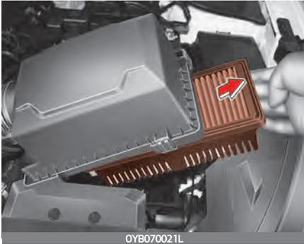
4. Schließen Sie die Luftfilterabdeckung mit den Befestigungsklammern.
