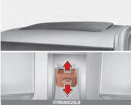
Drücken Sie zum Öffnen des Schiebedachs den Hebel des Schiebedachs nach oben, bis das Schiebedach sich in der gewünschten Position befindet.
