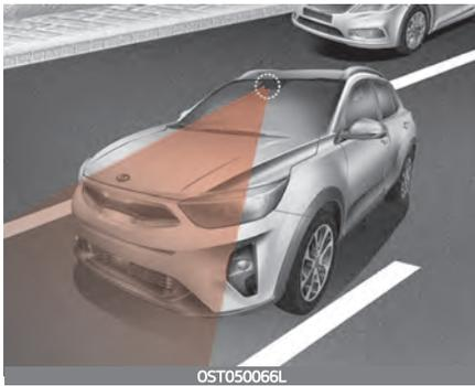
Die Frontkamera wird als Erkennungssensor verwendet, um Fahrbahnmarkierungen (oder Fahrbahnränder) zu erkennen. Die genaue Position des Detektors ist im Bild oben zu sehen.
