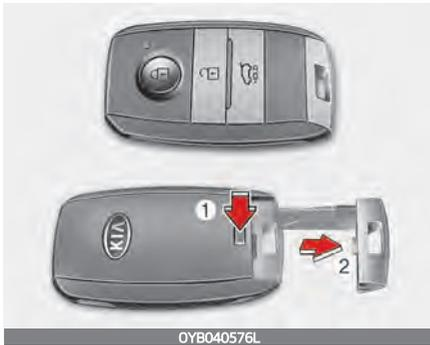
Um den mechanischen Schlüssel zu entfernen, drücken und halten Sie die Freigabetaste (1) und ziehen Sie den mechanischen Schlüssel (2) heraus.
