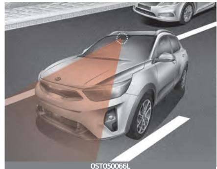
Die Frontkamera wird als Erkennungssensor für Fahrbahnmarkierungen (oder Straßenränder) und vorausfahrende Fahrzeuge verwendet.
