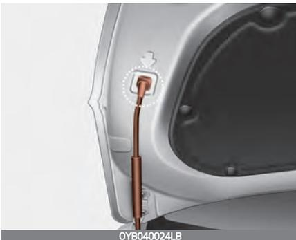
4. Stützen Sie die Haube mit der Stützstange ab.
