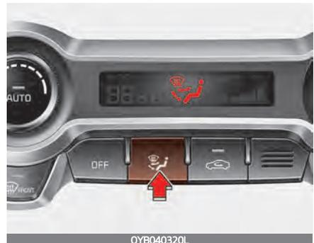
Die Modustaste steuert die Richtung des Luftstroms im Belüftungssystem.
