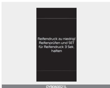
Die Warnleuchte (
