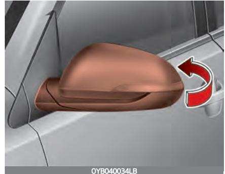
Um einen Außenspiegel anzuklappen, greifen Sie das Spiegelgehäuse und klappen Sie den Spiegel nach hinten zum Fahrzeug um.
