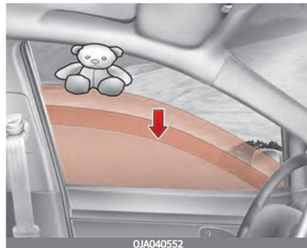
Wenn die Aufwärtsbewegung des Fensters durch einen Gegenstand oder ein Körperteil blockiert wird, erkennt der Fensterheber den Widerstand und stoppt die Aufwärtsbewegung. Danach senkt sich das Fenster um ca. 30 cm unter den oberen Rand, damit das Objekt entfernt werden kann.
