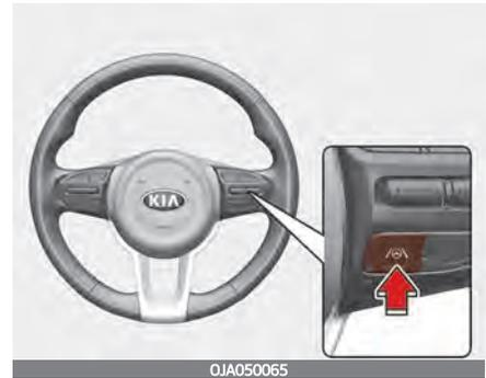
Halten Sie, wenn der Zündschalter bzw. der Knopf ENGINE START/ STOP (Motorstart/-stopp) in Posi- tion ON steht, die Spursicherheits- taste (🚗) auf dem Kombiinstru- ment gedrückt, um den Spurhal- teassistenten einzuschalten.
