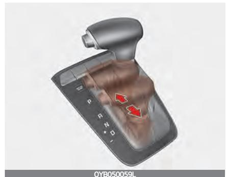
Den Sportmodus können Sie sowohl im Stand als auch während der Fahrt wählen. Bewegen Sie dazu den Wählhebel aus der Fahrstufe (D) in die manuelle Schaltgasse. Um in die Fahrstufe (D) zurückzugelangen, bewegen Sie den Wählhebel zurück in die Automatik-Schaltgasse.
