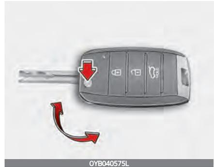
Um den Schlüssel auszuklappen, drücken Sie die Freigabetaste; daraufhin klappt der Schlüssel automatisch aus.
