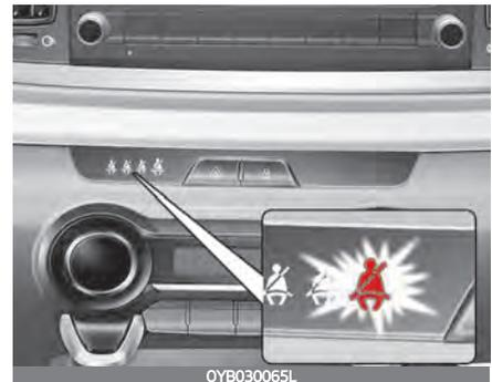
Als Erinnerung für den Beifahrer leuchtet die Warnleuchte für den Beifahrergurt nach jeder Drehung des Zündschalters oder des Knopfes ENGINE START/STOP (Motorstart/-stopp) auf ON ca. 6 Sekunden lang, unabhängig davon, ob der Gurt angelegt ist.
