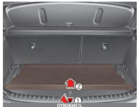
3. Ziehen Sie das Scharnier des Gepäckraumbodens bis zum Ende der Aussparung; es fällt dann weiter nach unten, und die Ladekapazität wird erhöht.
