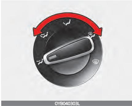
Der Modusschalter steuert die Richtung des Luftstroms im Belüftungssystem.
