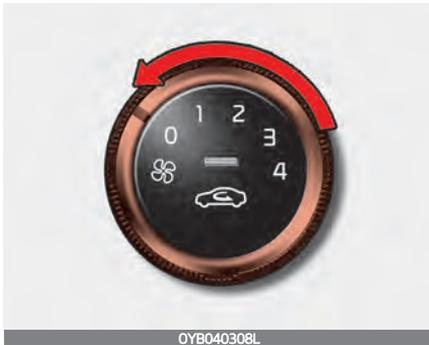
Zum Ausschalten des Gebläses drehen Sie den Reglerknopf für die Gebläsedrehzahl in die Stellung „0“.
