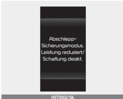
Wenn die vorstehende Warnung beim Ziehen eines Anhängers erscheint, kann zum Verhindern von Überhitzen des Motors/Getriebes die Leistung beschränkt werden bzw. das Schaltgetriebe möglicherweise nicht verfügbar sein.
