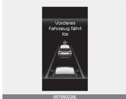
Wenn das vorausfahrende Fahrzeug losfährt, informiert der Hinweis, wenn vorderes Fahrzeug losfährt, den Fahrer durch die Meldung „Vorausfahrendes Fahrzeug fährt los“ auf dem Kombiinstrument und gibt einen Warnton aus.
