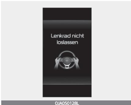
Wenn der Fahrer das Lenkrad mehrere Sekunden lang loslässt, während der LKA aktiviert ist, warnt die Funktion den Fahrer.
