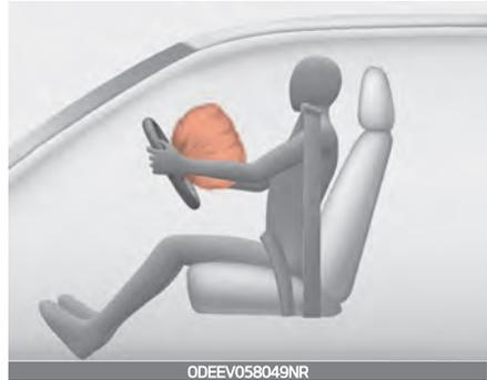
Bei der Auslösung trennen sich Sollrissnähte, die direkt in die Verkleidungen eingearbeitet sind, unter dem Druck der Airbagausdehnung. Die daraufhin entstehenden Öffnungen in den Abdeckungen erlauben die vollständige Ausdehnung der Airbags.
