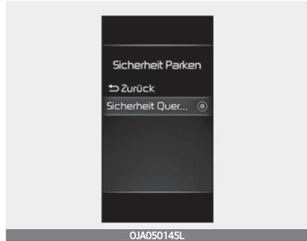
Wählen Sie, wenn der Zündschalter oder der Start-/Stopp-Knopf in Position ON steht, im Einstellungs Menü die Option „Fahrerassistenz“ → Parksicherheit → Querverkehrssicherheit hinten“, um das hintere Querverkehr-Warnsystem ein- bzw. auszuschalten.
