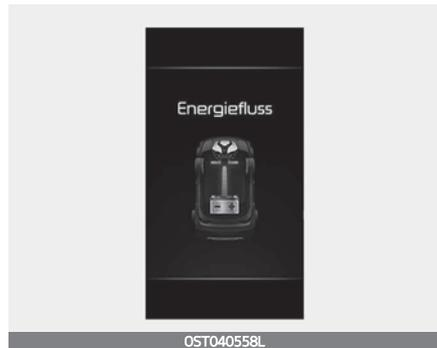
Strom vom Elektromotor und Verbrennungsmotor werden für den Antrieb des Fahrzeugs verwendet. (Batterie & Verbrennungsmotor → Rad)
