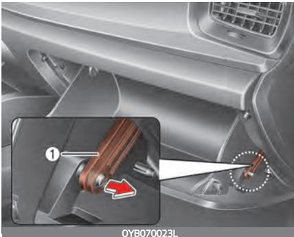
3. Bauen Sie das Filtergehäuse aus, während Sie die Verriegelung an der rechten Seite der Abdeckung.
