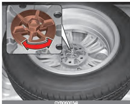
Drehen Sie die Flügelschraube, die das Ersatzrad fixiert, gegen den Uhrzeigersinn.
