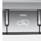
Wenn die Frischluftposition ausgewählt ist, tritt Luft von außen in das Fahrzeug ein und wird gemäß der ausgewählten Funktion erwärmt oder gekühlt.
