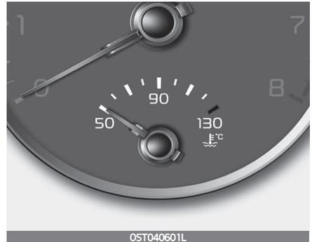
Dieses Messgerät zeigt die Temperatur des Motorkühlmittels an, wenn sich der Zündschalter oder der Start-/Stopp-Knopf in Position ON befindet.
