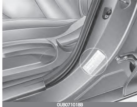
Alle Spezifikationen (Reifengröße und Reifendruck) befinden sich auf einem Aufkleber an der B-Säule der Fahrerseite.
