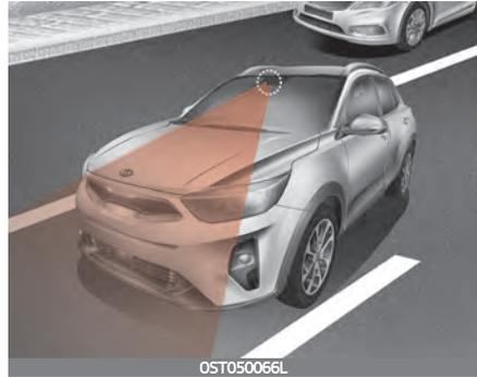
Die Frontkamera dient als Erkennungssensor. Sie erkennt während der Fahrt den Fahrstil und den Start eines vorfahrenden Fahrzeugs.
