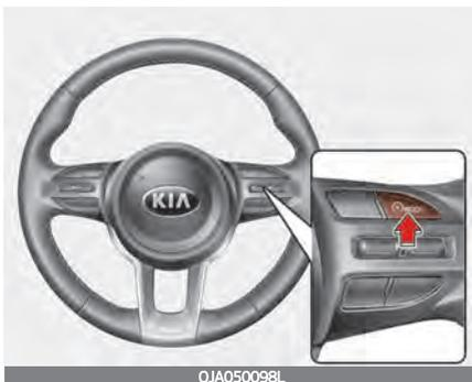
1. Drücken Sie die Fahrassistenz-Taste, um das System einzuschalten. Die TEMPOMAT-Kontrollleuchte im Kombiinstrument leuchtet danach auf.
