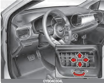
Die Düsen können separat mit dem Stellrad geöffnet und geschlossen werden. Um die Öffnung zu schließen, drehen Sie den Regler nach unten in die maximale Position.
