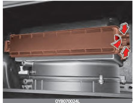
4. Ersetzen Sie den Luftfilter der Klimaanlage.
