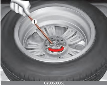
Wenn sich die Flügelschraube zur Radbefestigung schwer von Hand lösen lässt, können Sie sie problemlos mit dem Griff des Wagenhebers lösen.
