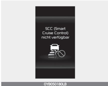
Wenn die Fahrassistenten-Taste (🚗) bzw. der Schalter RES+ oder SET- gedrückt wird und die Betriebsbedingungen der Funktion nicht erfüllt sind, erscheint die Meldung „Betriebsbedingungen der intelligenten Tempomatsteuerung nicht erfüllt“ auf dem Kombiinstrument, und es wird ein Warnton ausgegeben.
