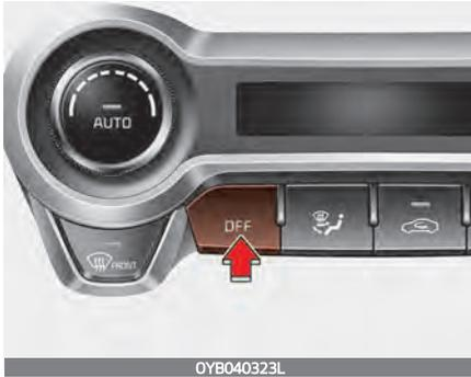
Drücken Sie die Taste OFF, um die Klimaanlage auszuschalten. Die Frischluft-/Umluftschaltung können jedoch weiterhin bedient werden, solange die Zündung eingeschaltet ist.
