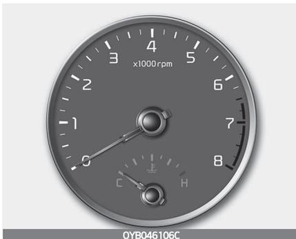
Der Drehzahlmesser zeigt die ungefähre Zahl der Motordrehungen pro Minute an (U/min).
