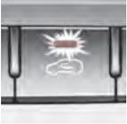
Wenn die Umluftposition ausgewählt ist, wird Luft aus dem Fahrgastraum durch das Heizsystem gesaugt und gemäß der ausgewählten Funktion erwärmt oder gekühlt.
