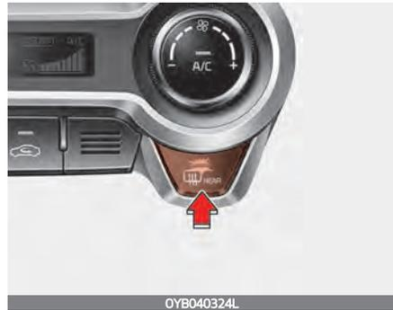
Die Heckscheibenheizung erwärmt bei laufendem Motor die Heckscheibe, um Raureif, Nebelniederschlag und dünnes Eis von der Scheibe zu entfernen.
