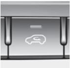
Wenn die Frischlufthposition ausgewählt ist, tritt Luft von außen in das Fahrzeug ein und wird gemäß der ausgewählten Funktion erwärmt oder gekühlt.
