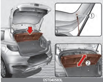
Dies ist eine Abdeckung für Gepäck im Gepäckraum und ermöglicht Ihnen, leichte Objekte auf der oberen Ablage zu platzieren. Beim Öffnen der Heckklappe kann die obere Verkleidung der Staufachabdeckung nach oben gezogen werden. Entfernen Sie den Haken (1), der von der Halterung herabhängt, um die Abdeckung in ihrer ursprünglichen Position zu verwenden.
