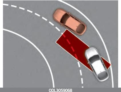
Das Totwinkel-Erkennungssystem funktioniert nicht ordnungsgemäß, wenn Sie auf einer kurvenreichen Straße fahren. Das System kann das Fahrzeug in der gleichen Fahrspur erkennen.
