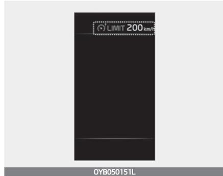
Um über die voreingestellte Geschwindigkeitsbegrenzung zu fahren, müssen Sie das Gaspedal stärker betätigen (mehr als ca. 80 %), bis der Kickdown-Mechanismus durch ein Klickgeräusch aktiviert wird. Dann blinkt die eingestellte Höchstgeschwindigkeit und es ertönt ein Warnsignal, bis Sie wieder auf eine Geschwindigkeit unter der Höchstgeschwindigkeit zurückkehren.
