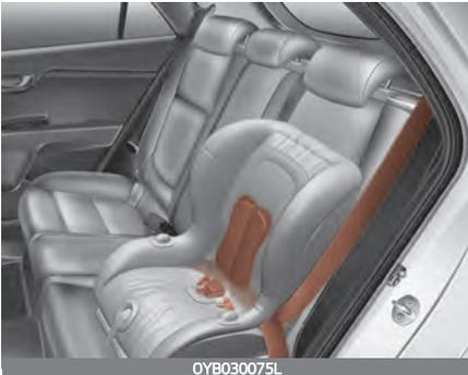
2. Schieben Sie die Schließzunge des Dreipunktgurts in das Gurtschloss. Achten Sie darauf, dass das Klickgeräusch deutlich hörbar ist. Positionieren Sie die Gurtschlosstaste so, dass sie im Notfall leicht erreichbar ist.
