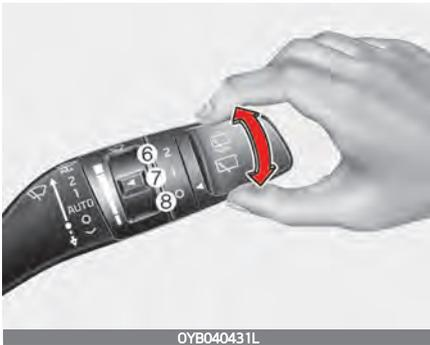
Der Heckscheibenwischer- und Waschanlagenschalter befindet sich am äußeren Ende des Scheibenwischerschalters. Drehen Sie den Schalter in die gewünschte Position, um den Heckwischer und die Heckscheibenwaschanlage in Betrieb zu setzen.
