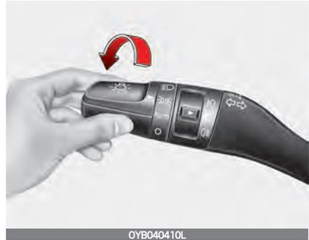
In der Schalterstellung „Standlicht“ (2. Stellung) sind Rückleuchten, Positionsleuchten, Kennzeichenbeleuchtung und Armaturenbeleuchtung eingeschaltet.
