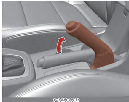
Um die Feststellbremse anzuziehen, treten Sie zuerst die Fußbremse und ziehen Sie danach den Hebel der Feststellbremse so weit wie möglich nach oben.
