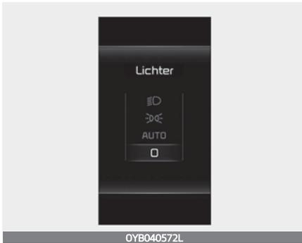
Diese Kontrollleuchte zeigt an, welche Außenleuchte mit der Lichtregelung ausgewählt wurde.
