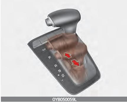
Den Sportmodus können Sie sowohl im Stand als auch während der Fahrt wählen. Bewegen Sie dazu den Wählhebel aus der Fahrstufe (D) in die manuelle Schaltgasse. Um in die Fahrstufe (D) zurückzugelangen, bewegen Sie den Wählhebel zurück in die Automatik-Schaltgasse.
