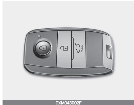
Mit einem Smart-Key können Sie Türen (und Heckklappe) ver- und entriegeln und auch den Motor starten, ohne dass Sie einen Schlüssel in ein Schloss stecken.
