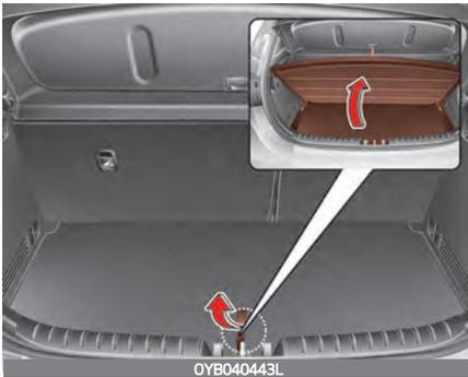
In diesem Staufach können Sie Verbandkasten, Warndreieck, Werkzeuge usw. unterbringen – Dinge, die Sie bei Bedarf schnell brauchen.
