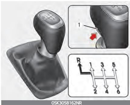
⇨ Der Schalthebel kann ohne Ziehen der Taste (1) bewegt werden.
