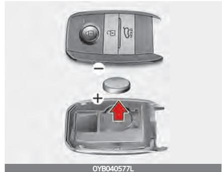
Der Handsender enthält eine 3 V-Lithium-Batterie, die normalerweise mehrere Jahre lang nicht ausgewechselt werden muss. Wenn die Batterie ersetzt werden muss, gehen Sie wie folgt vor:
