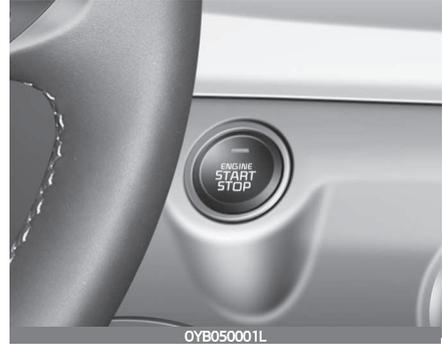
Wenn die vordere Tür geöffnet wird, leuchtet der Knopf ENGINE START/STOP (Motorstart/-stopp) auf. Das Licht erlischt etwa 30 Sekunden nach dem Schließen der Tür. Erlischt ebenfalls sofort, wenn die Diebstahlwarnanlage aktiviert wird.
