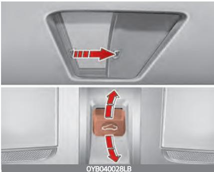
Ziehen Sie zum Öffnen des Schiebedachs den Hebel des Schiebedachs nach hinten.
