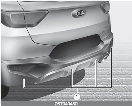
Die Einparkhilfe hinten unterstützt den Fahrer beim Rückwärtsfahren und gibt einen Warn- ton aus, wenn sie innerhalb einer Entfernung von 120 cm hinter dem Fahrzeug ein Hindernis erkennt.
