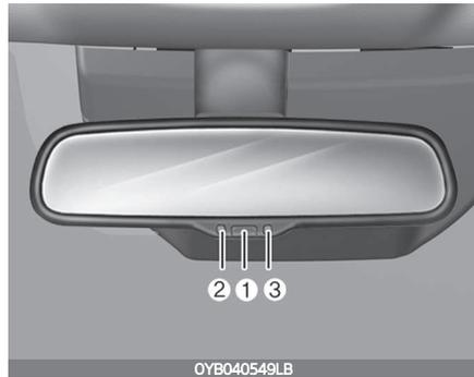
Der elektrische Innenspiegel regelt nachts oder im Halbdunkeln automatisch das Blendlicht hinter Ihnen fahrender Fahrzeuge. Der Sensor (3) im Spiegelglas stellt die vorhandene Lichtintensität im Bereich Ihres Fahrzeugs fest und er regelt automatisch das Blendlicht hinter Ihnen fahrender Fahrzeuge.
