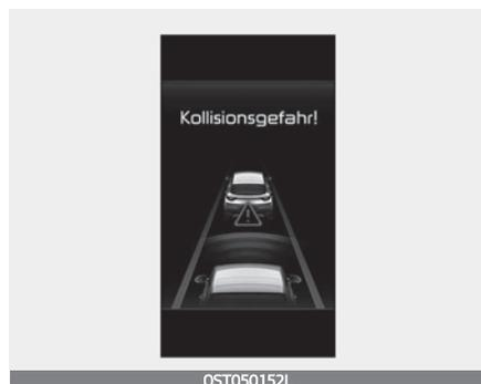
Wenn die intelligente Tempomatsteuerung in Betrieb ist, erscheint bei hohem Kollisionsrisiko mit dem vorausfahrenden Fahrzeug die Warnmeldung „Kollisionswarnung“ auf dem Kombiinstrument, und für den Fahrer wird ein Warnton ausgegeben. Achten Sie immer auf die Straßen- und Verkehrsverhältnisse und betätigen Sie ggf. das Bremspedal, um die Fahrgeschwindigkeit zu verringern und einen Sicherheitsabstand einzuhalten.
