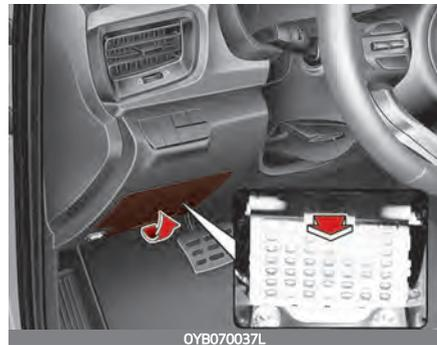
Ihr Fahrzeug ist mit einer Memory-Sicherung ausgestattet, die verhindert, dass sich die Fahrzeugbatterie bei längeren Standzeiten entlädt. Gehen Sie wie folgt vor, wenn Sie das Fahrzeug für längere Zeit außer Betrieb nehmen.
