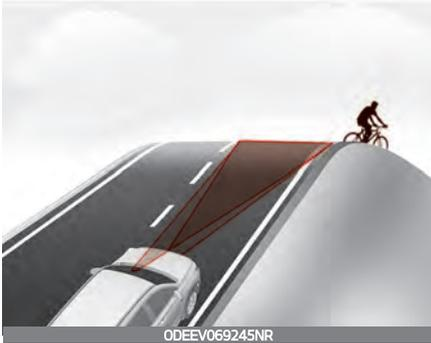
Die Leistung des Frontkollisions-Vermeidungsassistenten kann bei einer Bergauf- oder Bergabfahrt beeinträchtigt sein. Die Frontkamera oder der vordere Radarsensor erkennt das vorausfahrende Fahrzeug oder den Fußgänger bzw. Radfahrer vor dem Fahrzeug eventuell nicht.
