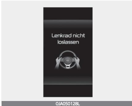
Wenn der Fahrer die Hände für einige Sekunden vom Lenkrad nimmt, erscheint die Warnmeldung „Hände am Lenkrad lassen“, und es wird in mehreren Stufen ein Warnton ausgegeben.
