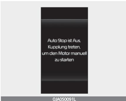
Der Motor lässt sich nicht starten, wenn der Wählhebel von der Neutralstellung N in die Fahrstufe D, den manuellen Modus oder den Rückwärtsgang R geschaltet wird, ohne bei automatisch angehaltenem Motor das Bremspedal zu betätigen. Wenn Sie in diesem Moment die Bremse betätigen, startet der Motor neu.
