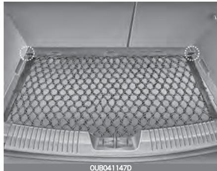
Um zu verhindern, dass sich das Ladegut unkontrolliert im Kofferraum umherbewegen kann, können Sie die 4 Halter im Kofferraum für die Befestigung eines Gepäcknetzes verwenden (ausstattungsabhängig).
