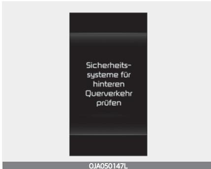
Wenn das hintere Querverkehr-Erkennungssystem nicht richtig funktioniert, erscheint die Warnmeldung „Hinteres Querverkehr-Erkennungssystem prüfen“ auf dem Kombiinstrument, und die Funktion schaltet sich automatisch aus oder wird in seiner Funktionalität eingeschränkt. Lassen Sie das Fahrzeug in diesem Fall von einer Fachwerkstatt überprüfen. Kia empfiehlt, sich an einen Kia-Vertragshändler/Servicepartner zu wenden.
