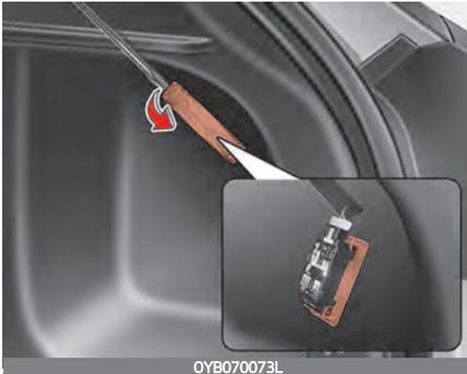
1. Hebeln Sie die Streuscheibe vorsichtig mit einem flachen Schraubendreher vom Gehäuse der Leuchte ab.
