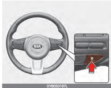
Bei jedem Drücken der Fahrzeugabstandstaste wechselt der Abstand zwischen Fahrzeugen wie folgt:
