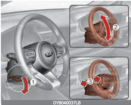
Um die Lenkradstellung zu verändern, ziehen Sie den Sicherungshebel (1) nach unten, bringen Sie das Lenkrad in den gewünschten Winkel (2) und in die gewünschte Höhe (3, ausstattungsabhängig) und klappen Sie danach den Sicherungshebel wieder nach oben, um die Lenksäule zu fixieren. Bringen Sie die Lenksäule immer vor Fahrtantritt in die gewünschte Stellung.
