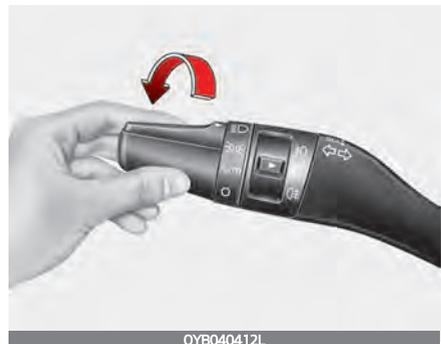
In der Schalterstellung „Scheinwerfer“ (3. Stellung) sind Scheinwerfer, Rückleuchten, Positionsleuchten, Kennzeichenbeleuchtung und Armaturenbeleuchtung eingeschaltet.
