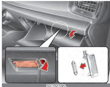
1. Lösen Sie die Leuchtenbaugruppe vorsichtig mit einem flachen Schraubendreher aus dem Gehäuse.
