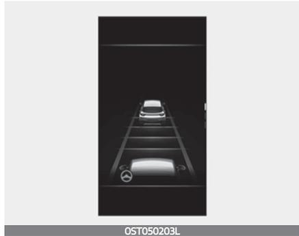
Wenn das vorausfahrende Fahrzeug oder beide Fahrspurmarkierungen erkannt werden und Ihre Fahrgeschwindigkeit unter 200 km/h liegt, leuchtet die grüne Kontrollleuchte (☺) des Kombiinstrumentes auf, und die Funktion hält das Fahrzeug in der Spur, indem es das Lenkrad steuert.
