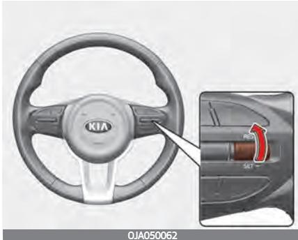
Wenn Sie die Tempomatgeschwindigkeit anders als mit dem Hebel deaktiviert haben und die Funktion noch aktiviert ist, wird die eingestellte Geschwindigkeit automatisch wieder aufgenommen, wenn Sie den Schalter nach oben bewegen. Wenn Sie den Schalter RES+ nach oben bewegen, wird die vorher eingestellte Geschwindigkeit wieder aufgenommen. Die Fahrgeschwindigkeit muss über 10 km/h liegen, damit die Funktion wieder genutzt werden kann.
