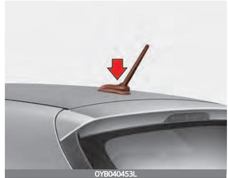
Ihr Fahrzeug nutzt eine Mikrostabantenne für den Empfang von Rundfunksignalen. Der Antennenstab ist abnehmbar. Um den Antennenstab zu entfernen, drehen Sie ihn entgegen dem Uhrzeigersinn heraus. Um die Antenne zu montieren, drehen Sie ihn im Uhrzeigersinn ein.
