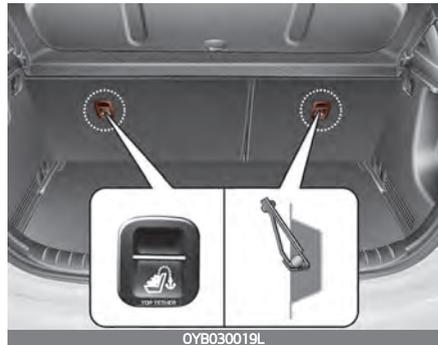
Die oberen Ankerpunkte für das Kinderrückhaltesystem befinden sich auf der Rückseite der Rücksitzlehnen.
