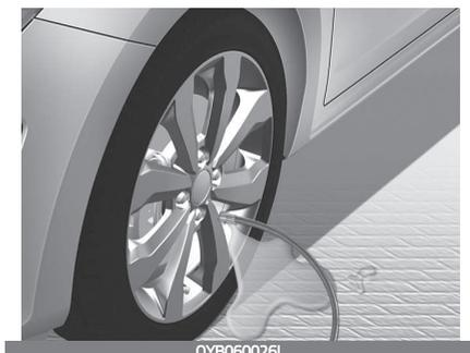
Montieren Sie den Dichtmitteleinfüllschlauch sicher am Ventil. Andernfalls kann Dichtmittel zurückfließen und möglicherweise den Einfüllschlauch verstopfen.
