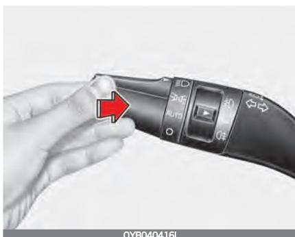
Um das Fernlicht einzuschalten, drücken Sie den Hebel nach vorn. Ziehen Sie den Hebel nach hinten, um das Abblendlicht einzuschalten.
