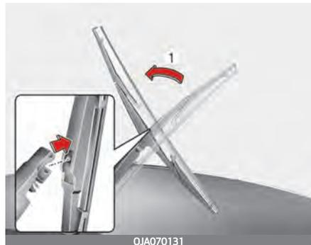
2. Bauen Sie das neue Wischerblatt ein, indem Sie den mittlerem Abschnitt in den Schlitz im Wischerarm drücken, bis er mit einem Klickgeräusch einrastet.
