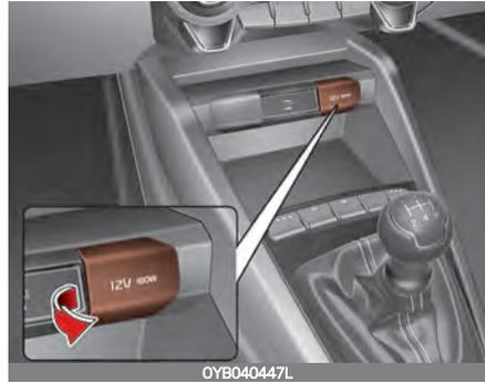
Die 12-V-Steckdosen sind für die Stromversorgung von Mobiltelefonen und anderen Geräten, die mit der Bordspannung des Fahrzeugs betrieben werden können, vorgesehen. Die Geräte sollten bei laufendem Motor weniger als 10 A verbrauchen.
