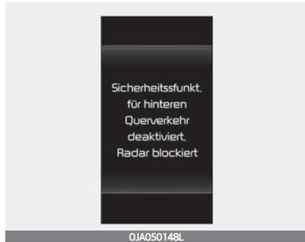
Wenn die hintere Stoßstange um das hintere Radar oder den hinteren Sensor mit Fremdkörpern wie Schnee oder Regen bedeckt ist oder ein Anhänger oder Träger angebracht ist, kann sich die Erkennungsleistung verringern und das hintere Querverkehr-Erkennungssystem vorübergehend einschränken oder deaktivieren.
