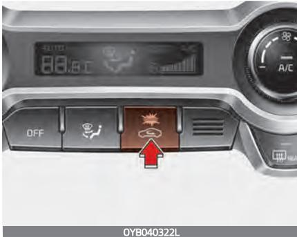
Mit dieser Schaltung können Sie zwischen der Zufuhr von Umgebungsluft (Frischluff) und der Umlüftung der im Fahrzeug befindlichen Luft (Umluft) wählen.
