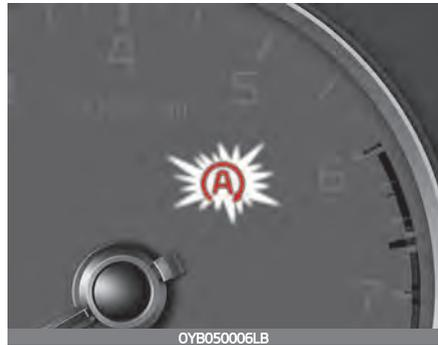
Das ISG-System wird durch eine Lampe am Kombiinstrument angezeigt. Falls Ihr Gerät mit einer Supervision-Instrumentenanzeige ausgestattet ist, erscheint der Hinweis auf dem LCD-Display.
