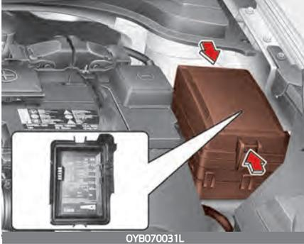
Sicherungskasten im Motorraum
