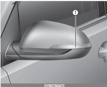
Wenn die Seitenblinkleuchte (LED) (1) nicht funktioniert, lassen Sie das Fahrzeug von einer Fachwerkstatt überprüfen.
