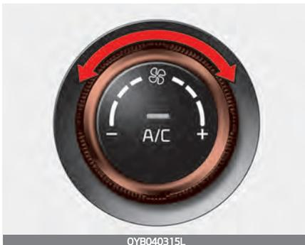
Durch den Lüfterdrehzahlregler kann die gewünschte Lüfterdrehzahl eingestellt werden.
