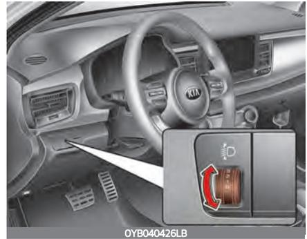
Um die Leuchtweite entsprechend der Anzahl der Insassen und dem zugelassenen Gewicht im Laderaum einzustellen, drehen Sie das Stellrad.
