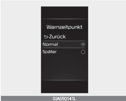
Wählen Sie, wenn der Zündschalter oder der Start-/Stopp-Knopf in Position ON steht, im Einstellungs Menü die Option „Fahrerassistenz“ → „Warnungszeitpunkt“, um die Aktivierungszeit für die erste Warnung des hinteren Querverkehr-Erkennungssystems zu ändern.
