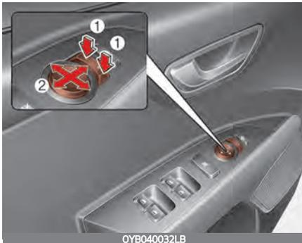
Der Schalter für die elektrische Spiegeleinstellung ermöglicht es Ihnen, den linken und rechten Außenspiegel einzustellen. Zu Einstellung beider Spiegel sollte sich die Zündung in der Position ACC befinden.
