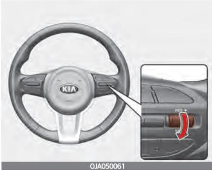
3. Drücken Sie den Schalter nach oben (in Richtung RES+) oder nach unten (in Richtung SET-) und lassen Sie ihn bei Erreichen der gewünschten Geschwindigkeit los. Drücken Sie den Schalter nach oben (in Richtung RES+) oder unten (in Richtung SET-) und halten Sie ihn gedrückt. Die Geschwindigkeit erhöht bzw. reduziert sich um 5 km/h.
