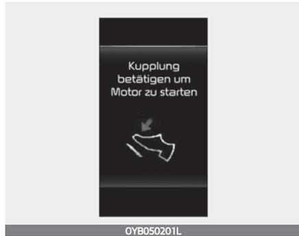
Wenn der Motor abgeschaltet ist oder das Fahrzeug sich bewegt, während der Gang eingelegt ist und das Kupplungspedal nicht betätigt wird, zeigt das System die vorstehende Warnmeldung an. Wenn der Fahrer zu diesem Zeitpunkt das Kupplungspedal bis zum Anschlag betätigt, startet der Motor automatisch neu. (Nur mit ISG-System mit verzögertem Neustart, außer MHEV)
