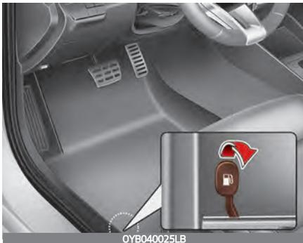
3. Ziehen Sie an der Tankklappe (1), um diese ganz zu öffnen.
