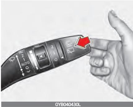
Ziehen Sie den Wischerhebel in der Schalterstellung (O) leicht nach hinten, um Waschwasser auf die Windschutzscheibe zu sprühen und die Scheibenwischer 1–3 Mal zu betätigen.
