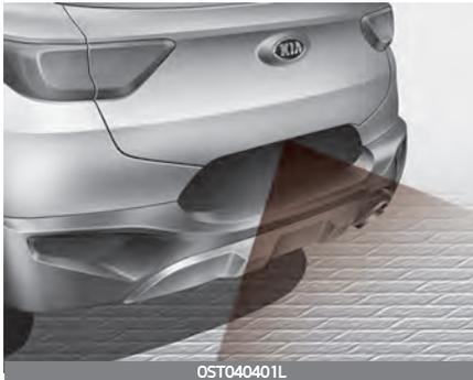
Der Rückspiegelmonitor wird aktiviert, wenn der Motor läuft und der Schalthebel in Stellung R (Rückwärtsgang) steht.
