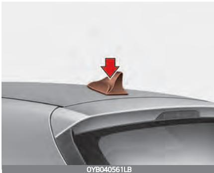
Die Haifischflossen-Antenne empfängt die Rundfunksignale.
