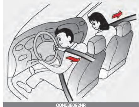
Ihr Fahrzeug ist mit Gurtstraffern an den Vordersitzen und an den äußeren Rücksitzen ausgestattet. Die Gurtstraffer sollen sicherstellen, dass die Gurte bei bestimmten Kollisionen eng am Oberkörper des Insassen anliegen. Die Gurtstraffer können bei Kollisionen ab einer bestimmten Aufprallstärke aktiviert werden.
