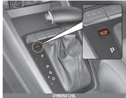
Wenn sich der Wählhebel von der Parkstufe (P) oder der Neutralstellung (N) bei betätigtem Bremspedal nicht in den Rückwärtsgang (R) bewegen lässt, halten Sie das Bremspedal gedrückt und gehen Sie wie folgt vor:
