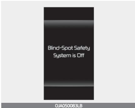
Wenn der Motor bei ausgeschaltetem System neu gestartet wird, erscheint auf dem Kombiinstrument die Meldung „Totwinkel-Sicherheitssystem ist ausgeschaltet“.
