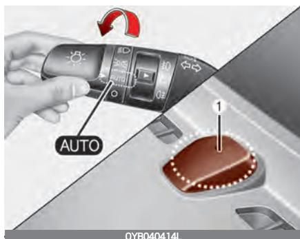
In der Schalterstellung AUTO (automatisches Fahrlicht) werden das Standlicht und die Scheinwerfer abhängig von den äußeren Lichtverhältnissen automatisch aus- und eingeschaltet.
