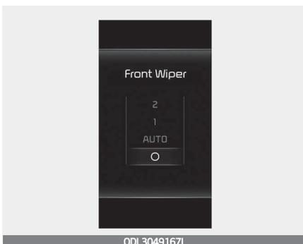
Diese Kontrollleuchte zeigt an, welche Wischergeschwindigkeit über die Wischersteuerung ausgewählt ist.
