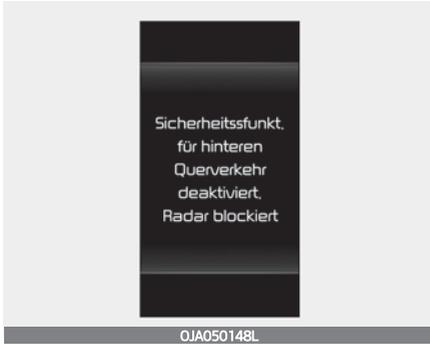
Wenn die hintere Stoßstange um das hintere Radar oder den hinteren Sensor mit Fremdkörpern wie Schnee oder Regen bedeckt ist oder ein Anhänger oder Träger angebracht ist, kann sich die Erkennungsleistung verringern und das hintere Querverkehr-Erkennungssystem vorübergehend einschränken oder deaktivieren.
