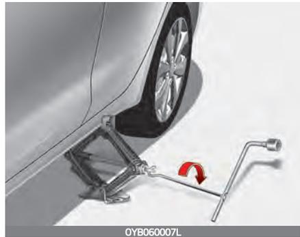
9. Lockern Sie die Radmuttern und drehen Sie sie mit der Hand von den Radbolzen. Heben Sie das Rad von den Radbolzen und legen Sie es auf die Seite, damit es nicht wegrollen kann. Um das Ersatzrad an das Fahrzeug anzubauen, nehmen Sie das Ersatzrad und halten Sie es so, dass die Bohrungen in der Felge mit den Radbolzen fluchten und schieben Sie das Rad auf die Radbolzen.
