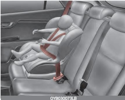
Ein Kinderrückhaltesystem mit Sicht in Fahrtrichtung hält den Körper des Kindes durch ein Gurtsystem. Transportieren Sie Kinder in einem Kinderrückhaltesystem mit Sicht in Fahrtrichtung und einem Gurtsystem, bis sie schwerer bzw. größer sind, als der Hersteller Ihres Kinderrückhaltesystems erlaubt.
