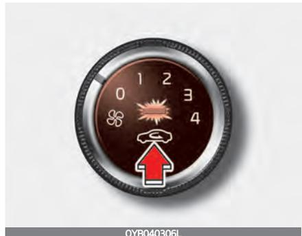
Die Frisch-/Umluft-Regelung wird verwendet, um die Frischluchtposition bzw. Umluftposition auszuwählen.
