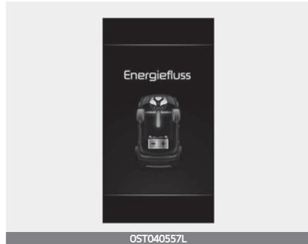
Der Motor und die Nutzbremsanlage laden die Hochspannungsbatterie. (Verbrennungsmotor & Rad → Batterie)
