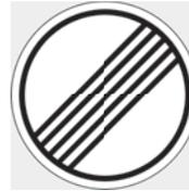
Das Symbol „Ende der Begrenzung“ wird im Kombiinstrument für Straßen in Deutschland angezeigt, für die keine Geschwindigkeitsbegrenzung gilt. Es wird solange angezeigt, bis das Fahrzeug ein anderes Geschwindigkeitsbegrenzungsschild erkennt.
