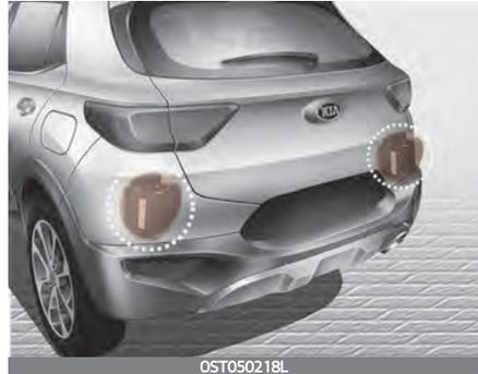
Das Totwinkel-Erkennungssystem erkennt und informiert den Fahrer, dass sich ein Fahrzeug mit hoher Geschwindigkeit im toten Winkel nähert.
