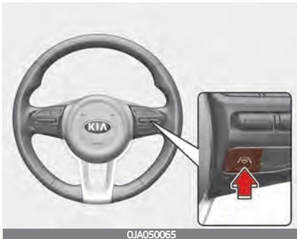
Drücken Sie, wenn der Zündschalter oder der Knopf ENGINE START/STOP (Motorstart/-stopp) in Position ON steht, die Taste für den Spurhalteassistenten am Lenkrad, um den Spurhalteassistenten einzuschalten. Die weiße oder grüne Kontrollleuchte (☺) auf dem Kombiinstrument leuchtet auf.
