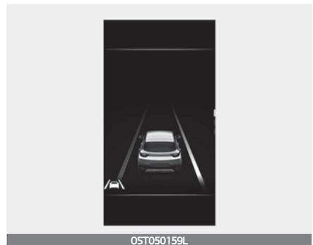
Wenn das Fahrzeug eine Spur überfährt, blinkt die überfahrene Spurmarkierung auf dem LCD-Display, und es wird ein Warnton ausgegeben.
