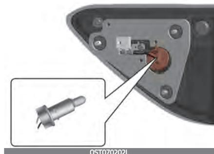
6. Setzen Sie die Lampenfassung in das Leuchtengehäuse ein, indem Sie die Rastnasen der Fassung auf die Aussparungen im Leuchtengehäuse ausrichten. Drücken Sie die Fassung in das Leuchtengehäuse und drehen Sie sie im Uhrzeigersinn.
