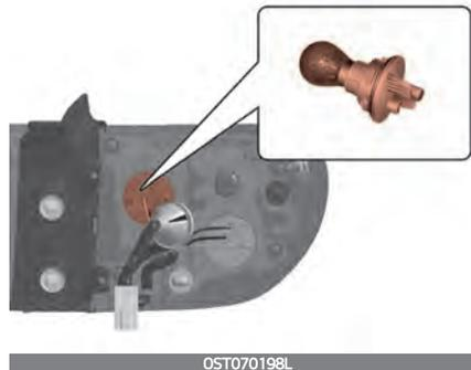
8. Setzen Sie die Lampenfassung in das Leuchtengehäuse ein, indem Sie die Rastnasen der Fassung auf die Aussparungen im Leuchtengehäuse ausrichten. Drücken Sie die Fassung in das Leuchtengehäuse und drehen Sie sie im Uhrzeigersinn.
