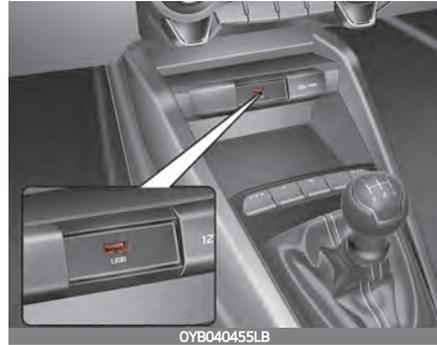
Sie können über einen USB-Anschluss ein USB-Gerät anschließen.
