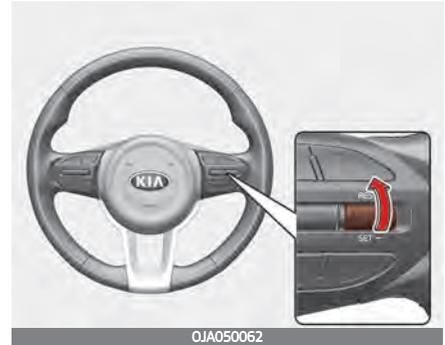
3. Lassen Sie das Gaspedal los. Das Fahrzeug hält die eingestellte Geschwindigkeit auch dann bei, wenn das Gaspedal nicht gedrückt wird.
