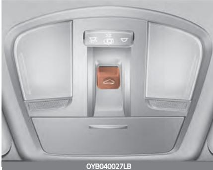
Wenn Ihr Fahrzeug mit einem Schiebedach ausgestattet ist, können Sie das Schiebedach über die Schiebedachhebel in der Dachkonsole aufstellen oder aufschieben.
