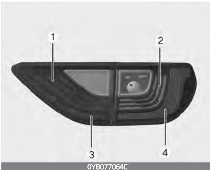
Wenn die Brems- und Rückleuchte (LED) (1,2,3,4) nicht funktioniert, lassen Sie das Fahrzeug von einer Fachwerkstatt überprüfen.
