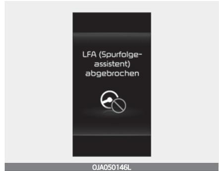
Wenn der Fahrer nach der Lenkradwarnung immer noch nicht die Hände am Lenkrad hat, erscheint die Warnmeldung „Spurhalteassistent (LFA) deaktiviert“ und der Spurhalteassistent (LFA) wird automatisch deaktiviert.
