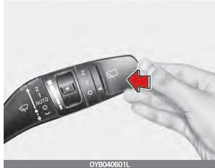
Drücken Sie den Hebel von Ihnen weg oder drehen Sie den Scheibenwischerschalter zweimal nach oben, um Waschwasser auf die Heckscheibe zu sprühen und die Heckscheibenwischer 1-3 Mal wischen zu lassen. Der Sprüh- und Wischvorgang wird fortgesetzt, bis Sie den Hebel freigeben.
