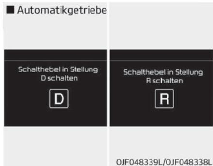
Wenn die oben erwähnte Meldung mit einem Piepton ausgegeben wird, legen Sie den Gang ein und fahren das Fahrzeug mit betätigtem Bremspedal.
