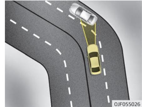
Das FCA-System erkennt möglicherweise bei der Fahrt in einer Kurve ein Fahrzeug in der benachbarten Spur. In diesem Fall kann das System unnötigerweise den Fahrer alarmieren und die Bremse anwenden.
