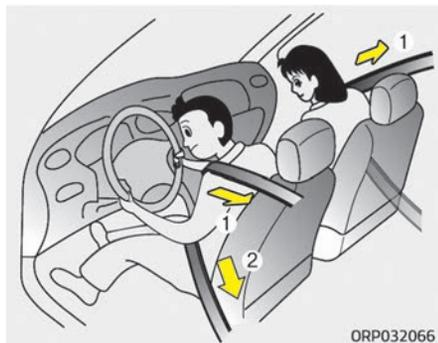
Ihr Fahrzeug ist mit Sicherheitsgurten und Gurtstraffern für den Fahrer- und Beifahrersitz ausgestattet (Gurtrolle mit Gurtstraffer). Der Sicherheitsgurt für den Fahrer ist mit Notspannvorrichtung (EFD) ausgestattet (ausstattungsabhängig).
