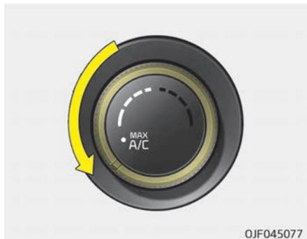
Der Modus MAX A/C wird verwendet, um den Fahrzeuginnenraum schneller abzukühlen.
