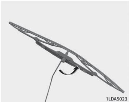
1. Heben Sie den Wischerarm an und drehen Sie das Wischerblatt, um an die Kunststoffklammer zu gelangen.
