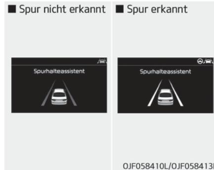
Wenn die Geschwindigkeit des Fahrzeugs über 60 km/h liegt und das System die Fahrspurmarkierung erkennt, ändert sich die Farbe von grau auf weiß.
