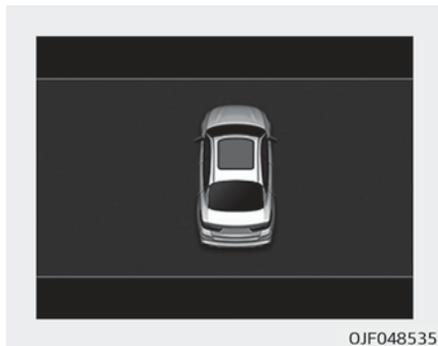
Wenn der Fahrer den Zündschlüssel abzieht (Smart-Key: den Motor abstellt), obwohl das Schiebedach nicht vollständig geschlossen ist, ertönt ca. 4 Sekunden ein Warnsignal, und es erscheint eine Nachricht auf dem LCD-Display. Schließen Sie das Schiebedach sicher, wenn Sie Ihr Fahrzeug verlassen.
