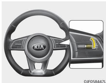
Wenn die automatische Geschwindigkeitsregelung deaktiviert wurde, ohne dass die TEMPOMAT/⊞MODE-Taste betätigt wurde (und wenn das System weiterhin eingeschaltet ist), wird die Regelung der zuletzt eingestellten Dauergeschwindigkeit automatisch dadurch aktiviert, wenn der RES+ Schalter gedrückt wird.
