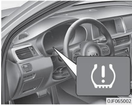
2. Positionsanzeige - Geringer Reifendruck (auf LCD-Display)
