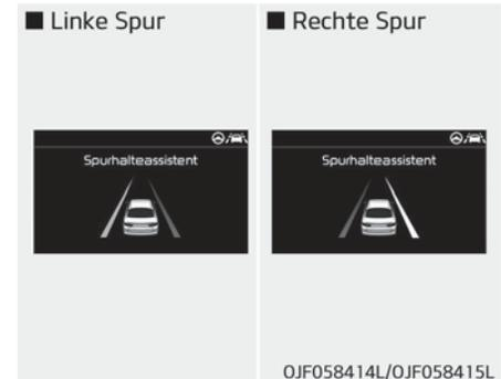
Wenn das Fahrzeug die Fahrspur verlässt, blinkt die Fahrspurmarkierung, die Sie überfahren, auf dem LCD-Display.
