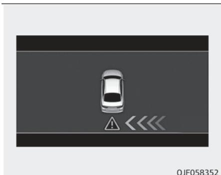
Wenn das von den Sensoren erkannte Fahrzeug sich Ihrem Fahrzeug nähert, ertönt das Warnsignal, die Warnleuchte am Außenspiegel blinkt und eine Meldung erscheint auf dem LCD-Display.
