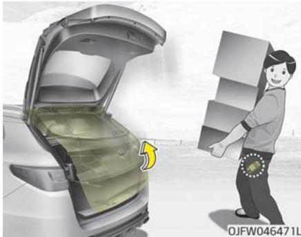
Wenn das Fahrzeug mit einem Smart-Key ausgestattet ist, kann die Heckklappe berührungslos mit dem intelligenten Heckklappensystem geöffnet werden.
