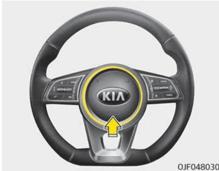
Um die Hupe zu betätigen, drücken Sie den mit dem Hupensymbol gekennzeichneten Bereich auf Ihrem Lenkrad (siehe Abbildung). Die Hupe ertönt nur, wenn Sie den gekennzeichneten Lenkradbereich drücken. Prüfen Sie die Hupe regelmäßig, damit Sie sicher sein können, dass die Hupe in Ordnung ist.
