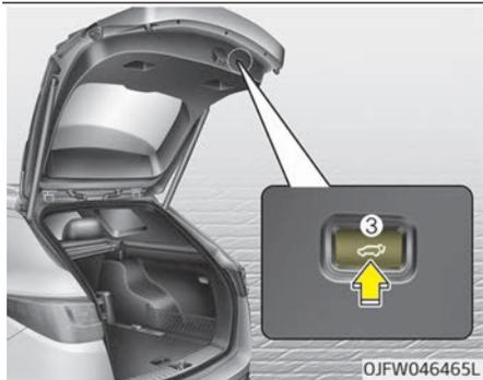
1. Taste zum Öffnen/Schließen der elektrischen Heckklappe
