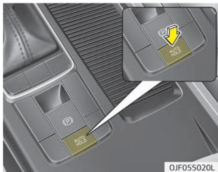
1. Wenn die Fahrertür, die Motorhaube und der Kofferraum geschlossen sind, schnallen Sie sich an oder drücken Sie das Bremspedal und dann die Taste zum automatischen Halten. Die weiße AUTO HOLD-Kontrollleuchte leuchtet, d. h., das System ist betriebsbereit.
