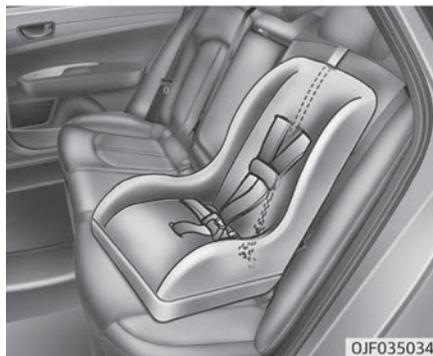
1. Führen Sie das obere Halteband des Kinderrückhaltesystems über die Rücksitzlehne. Befolgen Sie bei der Verlegung des oberen Haltebandes die Anweisungen des Kindersitzherstellers.
