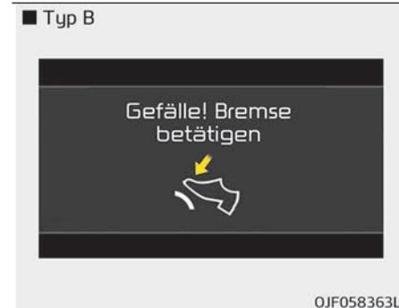
Diese Warnmeldung erscheint, wenn das Fahrzeug langsam auf einer Böschung fährt und das Fahrzeug erkennt, dass das Bremspedal nicht betätigt wird.
