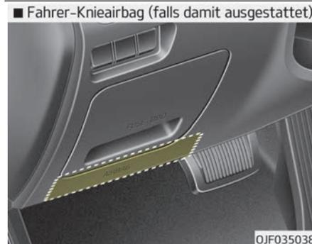
Ihr Fahrzeug ist mit einem ergänzenden Rückhaltesystem (Airbagsystem) und Dreipunktgurten am Fahrer- und Beifahrersitz ausgestattet.
