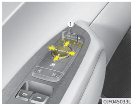
Der Schalter für die elektrische Spiegelseinstellung ermöglicht es Ihnen, den linken und rechten Außenspiegel einzustellen. Stellen Sie zuerst den Schalter (1) in die Stellung R oder L, um den rechten oder linken Außenspiegel auszuwählen. Drücken Sie danach den entsprechenden Teil der Einstelltaste (▲), um den Spiegel nach oben, unten, innen oder außen zu verstellen.
