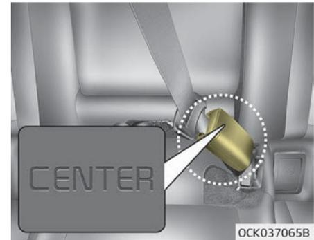
Wenn der hintere mittlere Sicherheitsgurt angelegt werden soll, muss das Gurtschloss mit der Beschriftung „CENTER“ verwendet werden.
