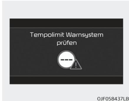
Wenn ISLW nicht ordnungsgemäß funktioniert, erscheint einige Sekunden lang diese Warnmeldung. Nachdem die Warnmeldung nicht mehr angezeigt wird, leuchtet die Hauptwarnleuchte.
