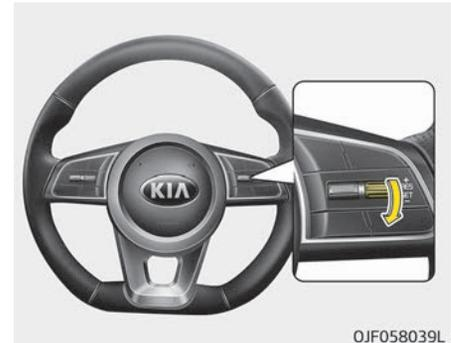
3. Drücken Sie den Hebel nach unten (in Richtung SET-) und lassen Sie ihn bei Erreichen der gewünsch-ten Geschwindigkeit los. Die eingestell-te Geschwindigkeit und der Ab-stand zum vorausfahrenden Fahr-zeug erscheinen auf dem LCD-Bild-schirm.
