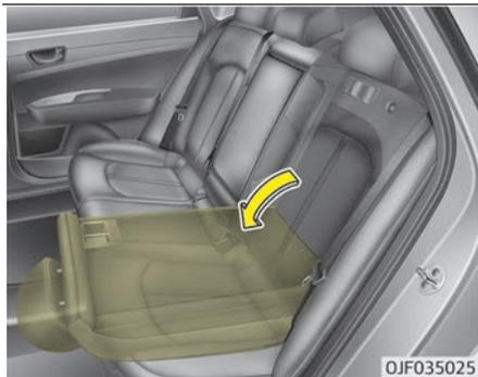
4. Ziehen Sie im Kofferraum den Verriegelungsknopf für die Sitzbank (1) und klappen Sie diese anschließend nach vorn um.
