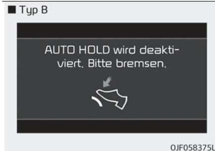
Wenn der Wechsel von Auto Hold (automatisches halten) zu EPB nicht ordnungsgemäß funktioniert, ertönt ein Warnsignal, und es erscheint eine Meldung.
