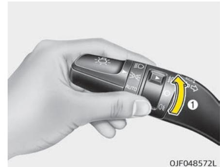
Die Nebelscheinwerfer sollen die Sicht bei schlechten Sichtbedingungen, beispielsweise Nebel, Regen oder Schnee verbessern. Die Nebelscheinwerfer werden eingeschaltet, wenn der Nebelscheinwerferschalter (1) nach dem Einschalten des Standlichts in die Stellung EIN gedreht wird.
