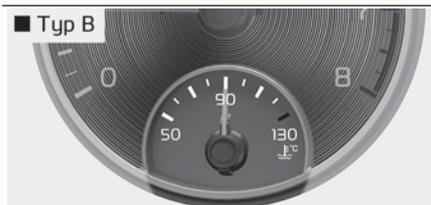
Dieses Messgerät zeigt die Temperatur des Motorkühlmittels an, wenn sich der Zündschalter oder der Knopf ENGINE START/STOP (Motorstart/-stop) in der Position ON befindet.
