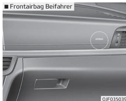
Das SRS-System besteht aus Airbags, die unter einer Abdeckung in der Mitte des Lenkrads, im Kniepolster unterhalb der Lenksäule und auf der Beifahrerseite im Armaturenbrett über dem Handschuhfach installiert sind.
