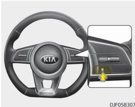
Diese Funktion ermöglicht Ihnen die Programmierung des Fahrzeugs, um einen relativen Abstand zum vorausfahrenden Fahrzeug einzustellen, ohne das Gaspedal oder das Bremspedal zu betätigen.
