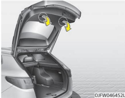
Drücken Sie die Heckklappe fest nach unten. Vergewissern Sie sich, dass die Heckklappe vollständig im Schloss eingerastet ist.
