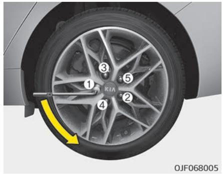
6. Lösen Sie alle Radmuttern um eine Umdrehung gegen den Uhrzeiger-
