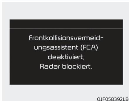
Wenn die Sensorabdeckung mit Schnee, Schmutz oder Verunreinigungen zuge-setzt ist, ist die FCA-Funktion möglicherweise vorübergehend nicht verfügbar. In diesem Fall erscheint eine Warnmeldung auf dem LCD-Display. Nach Entfernen der Ablagerungen funktioniert das System normal. Entfernen Sie Schmutz, Schnee und Fremdkörper und reinigen Sie die Abdeckung des Radarsensors, bevor Sie das FCA-System in Betrieb nehmen.
