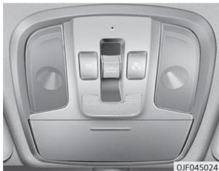
Wenn Ihr Fahrzeug mit einem Schiebedach ausgestattet ist, können Sie das Schiebedach über die Schiebedachhebel in der Dachkonsole aufstellen oder auf-schieben und schließen.
