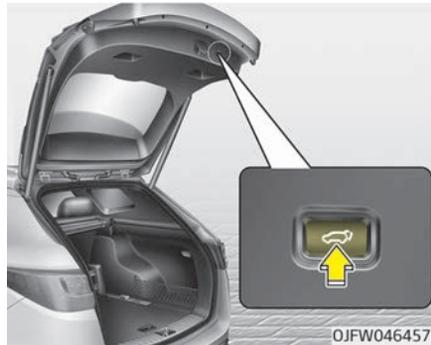
Der Fahrer kann die Höhe einer vollständig geöffneten Heckklappe einstellen, indem er die unten stehenden Anweisungen befolgt.
