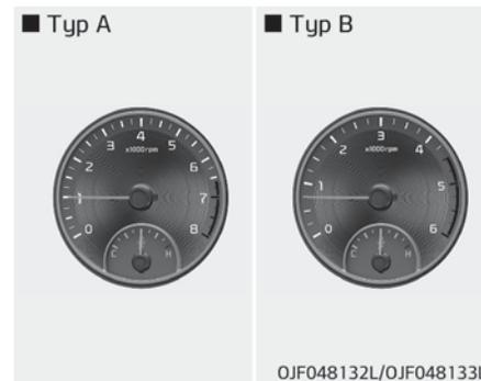
Der Drehzahlmesser zeigt die ungefähre Zahl der Motordrehungen pro Minute an (U/min).
