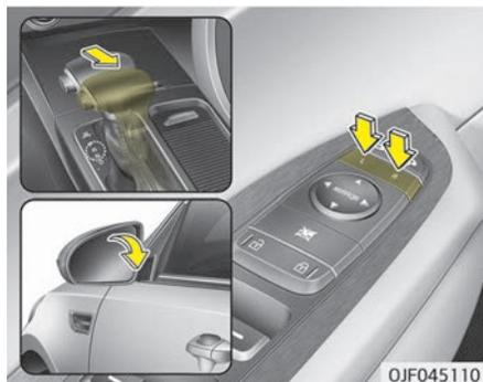
Wenn Sie den Wählhebel in die Position R (Rückwärtsgang) bringen, werden die Außenrückspiegel nach unten verstellt, um das Rückwärtseinparken zu erleichtern.
