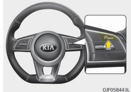
1. Drücken Sie die Taste CRUISE/CRUISE/MODE am Lenkrad, um das System
