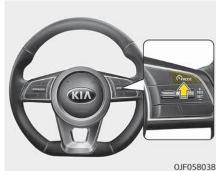
1. Drücken Sie zweimal den Tempomat-Schalter (MODE) am Lenkrad, um das System einzuschalten.
