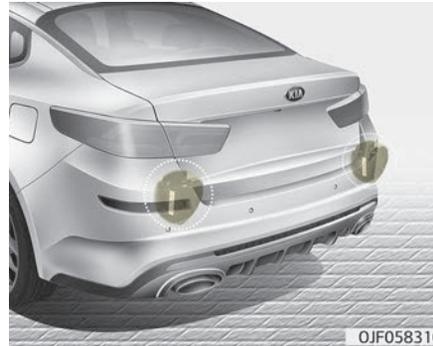
Die Sensoren befinden sich im hinteren Stoßfänger. Halten Sie den hinteren Stoßfänger sauber, damit das System einwandfrei funktioniert.
