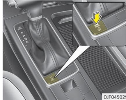
Wenn sich der Zündschlüssel bzw. der Knopf ENGINE START/STOP (Motorstart/-stopp) in der Position ON befindet, wird durch Betätigung der Taste für die Lenkradheizung das Lenkrad erwärmt. Daraufhin leuchtet die Kontrollleuchte der Taste auf.
