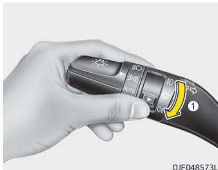
Um das Nebelschlusslicht einzuschalten, schalten Sie zuerst das Fahrlicht ein und drehen Sie danach den Schalter (1) für das Nebelschlusslicht in die Stellung EIN.
