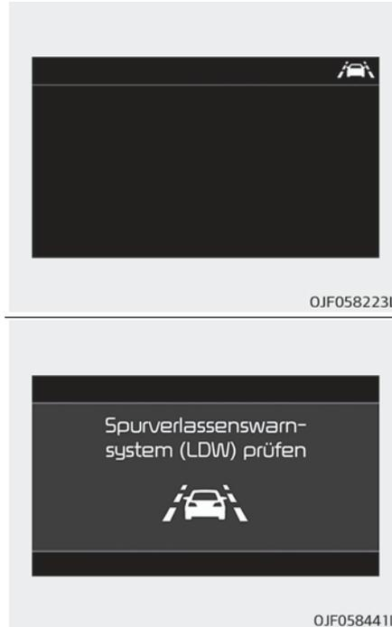
Wenn das LDW nicht ordnungsgemäß funktioniert, leuchtet die Warnleuchte, und die Warnmeldung erscheint einige Sekunden. Nachdem die Warnmeldung nicht mehr angezeigt wird, leuchtet die Hauptwarnleuchte.
