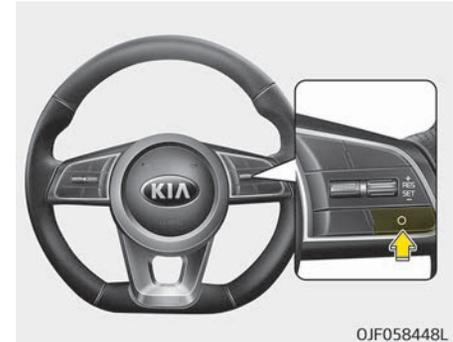
Wenn Sie den CANCEL/O-Schalter einmal drücken, wird die eingestellte Geschwindigkeitsbegrenzung deaktiviert, das System aber nicht ausgeschaltet. Wenn Sie die Geschwindigkeitsbegrenzung zurücksetzen wollen, drücken Sie den Hebel nach oben (in Richtung RES+) oder nach unten (in Richtung SET-), um die gewünschte Geschwindigkeit einzustellen.
