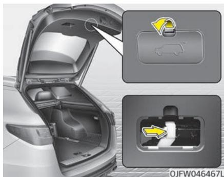
Ihr Fahrzeug ist mit einem Hebel für die Notentriegelung der Heckklappe ausgerüstet. Der Hebel befindet sich unten an der Heckklappe. Wenn eine Person versehentlich im Laderaum eingeschlossen wurde, kann die Heckklappe folgendermaßen geöffnet werden:
