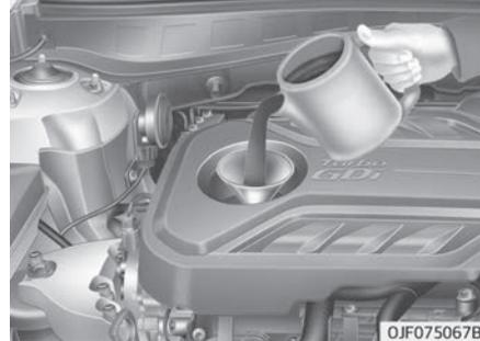
Verwenden Sie einen Trichter, um zu vermeiden, dass Öl vergossen wird und auf Motorteile läuft.
