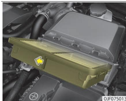
2. Entriegeln Sie, indem Sie den Spannhebel nach unten ziehen.
