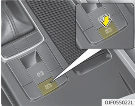
Um den automatischen Haltebetrieb zu stornieren, drücken Sie den Schalter für Automatisches Halten. Die Kontrollleuchte für Auto Hold erlischt. Um die Auto Hold-Funktion bei stehendem Fahrzeug zu stornieren, drücken Sie den Auto Hold-Schalter, während Sie das Bremspedal betätigen.
