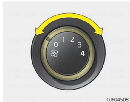
Das Gebläse kann nur bei eingeschalteter Zündung bedient werden. Mit diesem Drehknopf können Sie die Gebläsedrehzahl einstellen, um den aus den Luftdüsen strömenden Luftstrom zu regulieren. Um die Gebläsedrehzahl einzustellen, drehen Sie den Knopf nach rechts, um die Gebläsedrehzahl zu erhöhen oder nach links, um die Drehzahl zu verringern. In der Schalterstellung "0" ist das Gebläse abgeschaltet.
