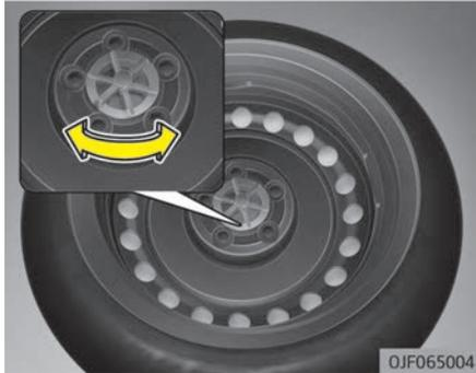
Drehen Sie die Flügelschraube, die das Ersatzrad fixiert, gegen den Uhrzeigersinn.
