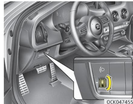
Um die Leuchtweitenregulierung entsprechend der Anzahl der Insassen und dem zugeladenen Gewicht im Laderaum einzustellen, drehen Sie das Stellrad.
