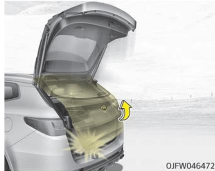
Wenn die elektrische Heckklappe beim elektrischen Öffnen und Schließen durch einen Gegenstand oder ein Körperteil blockiert wird, erkennt die elektrische Heckklappe einen Widerstand.
