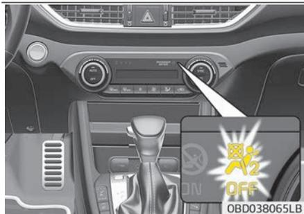
Um den Beifahrer-Frontairbag zu deaktivieren, schieben Sie den Fahrzeug-Hauptschlüssel in den Schalter "Beifahrer-Frontairbag ON/OFF" und drehen Sie ihn in die Stellung OFF (Aus).
