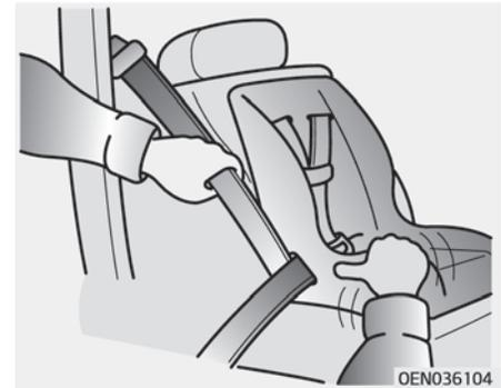
3. Sorgen Sie für eine möglichst hohe Gurtspannung, indem Sie das Kinderrückhaltesystem beim Aufrollen des Schultergurtes hinunterdrücken.
