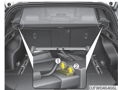
1. Drücken Sie die Entriegelungstaste (1) an den Enden beider Seiten.
