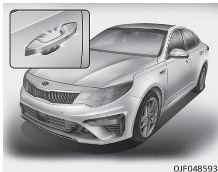
Wenn alle Türen (und der Kofferraum/die Heckklappe) geschlossen und verriegelt sind, leuchtet die Innenraumleuchte für ca. 15 Sekunden auf, wenn eine der folgenden Aktionen durchgeführt wird.
