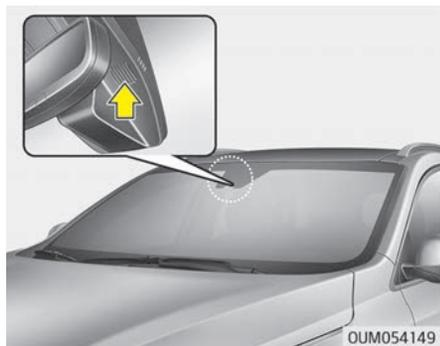
Das System zeigt dem Fahrer eventuelle Geschwindigkeitsbegrenzungen und Überholverbote sowohl im Kombiinstrument als auch auf dem Navigationsbildschirm an. ISLW erkennt Verkehrsschilder mit einem Kamerasystem oben an der Windschutzscheibe. Für die Anzeige der Geschwindigkeitsbegrenzungen nutzt ISLW auch Navigationsdaten.
