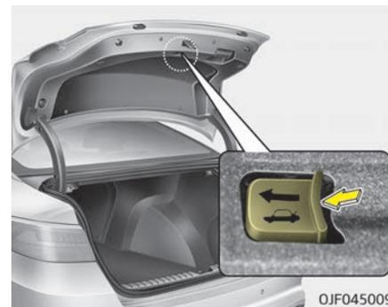
Ihr Fahrzeug ist mit einem Freigabehebel für die Kofferraumklappe in dem Kofferraum ausgestattet. Wenn eine Person versehentlich im Kofferraum eingeschlossen wird, kann die Person den Handgriff in Pfeilrichtung bewegen, um das Kofferraumschloss zu entriegeln und den Kofferraumdeckel zu öffnen.
