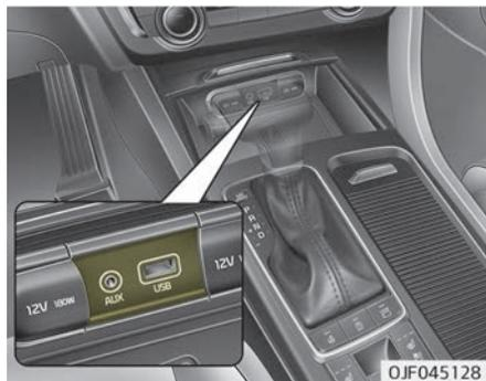
Sie können Audiogeräte an den AUX-Anschluss, USB-Geräte an den USB-Anschluss und iPod® betreibt.
