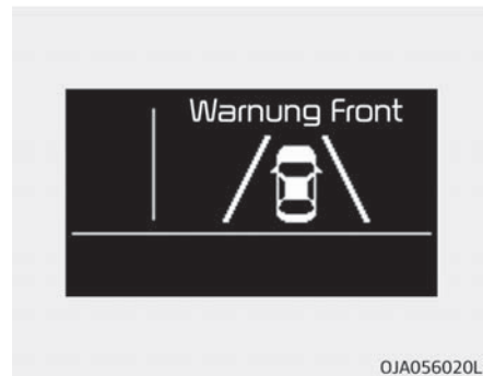
Die Warnmeldung erscheint auf dem LCD-Display für Warnanzeigen.
