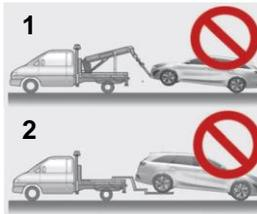
Hinweis: Nicht mit Abschleppschnur abschleppen (1). Das Fahrzeug darf nicht abgeschleppt werden, während die Vorderräder den Boden berühren. Hierbei kann es zu Schäden am Fahrzeug kommen (2).
