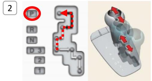
Bei Automatikgetriebe: Schalthebel in Parkstellung (P) bringen
