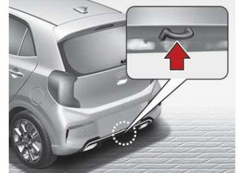
Abschlepphaken befindet sich in der Werkzeugbox in der Heckklappe
