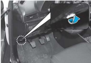
Entriegelungshebel betätigen, um die Motorhaube zu entriegeln.
