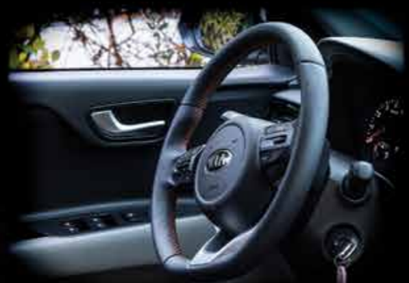
Remek fogású a részben perforált bőrrel bevont, narancsszínű cérnával varrt okoskormány. A kormányoszlop négy irányban mozgatható
