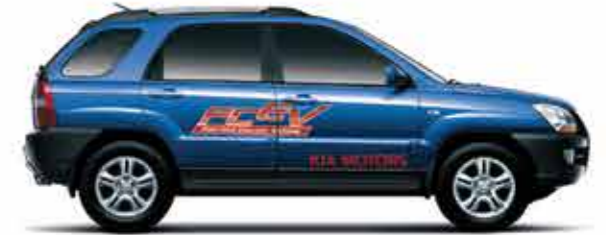
Fontos kísérleti modell volt a tüzelőanyag-cellás (FCEV) hajtáslánccal épített Sportage 2005-ben
