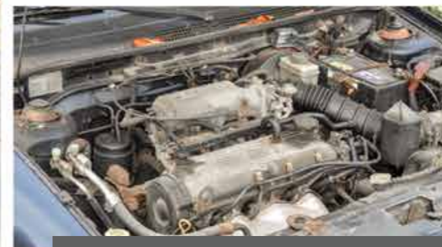
Rendben teszi a dolgát a négyhengeres SOHC-motor. A rugótornyok teljesen rozsdamentesek, a Sephia mindig gond nélkül teljesítette a műszaki vizsgát
