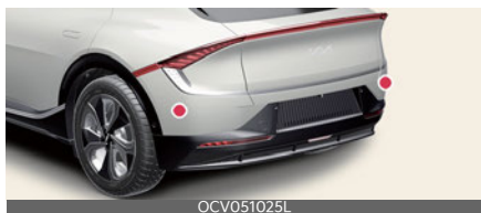
Hjørneradar bak (utstyrsavhengig)
