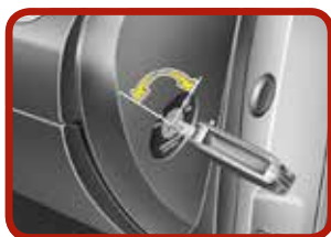
Strömbrätare för framsätesspassagerarens frontkrockudde [3]
